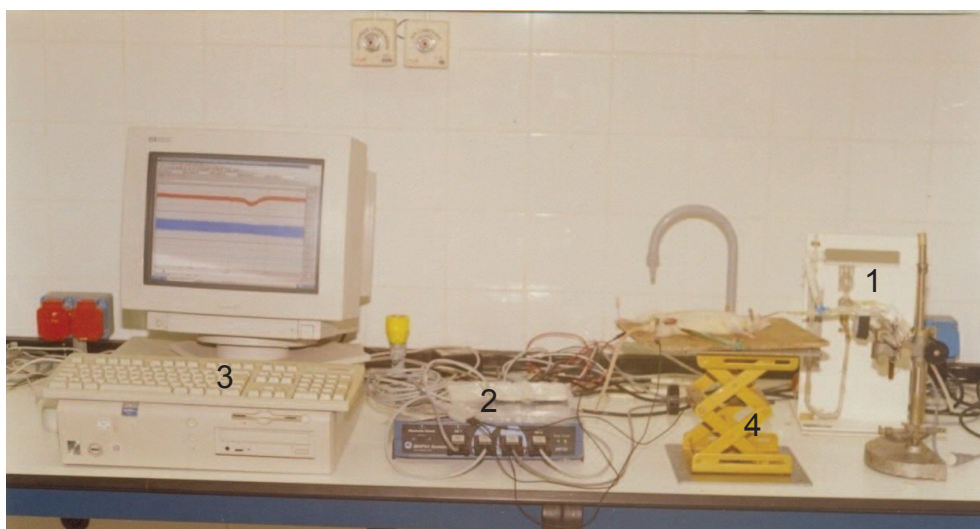
Figure 13. Dispositif d'enregistrement de la pression artérielle par voie directe. 1 : transducteur ; 2 Biopac « MP 35 » ; 3 : ordinateur ; 4 : potence réglable.
