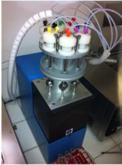
Figure 29 : USP4--- A gauche : Pompe péristaltique – A droite : circuit de circulation USP4 avec un échantillon de prothèse imprégnée de rifampicine en place
