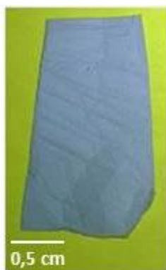
Figure IV.6. Photo d'un tissu d'une fibre de PAN/NTCs fabriquée par électrofilage.
