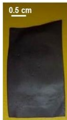
Figure IV.7. Photo d'un tissu d'une fibre de PAN/NTCs après carbonisation
