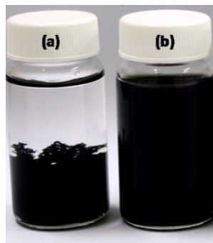
Figure I.7. Dispersion de nanotubes de carbone multi-paroi dans le DMF obtenues après 15 minutes dans le bain à ultrasons : (a) mauvaise dispersion et (b) bonne dispersion.
