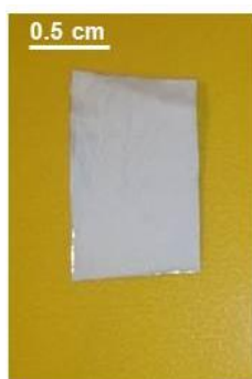
Figure IV.5. Photo d'un tissu de fibre de Polyacrylonitrile obtenu par électrofilage.
