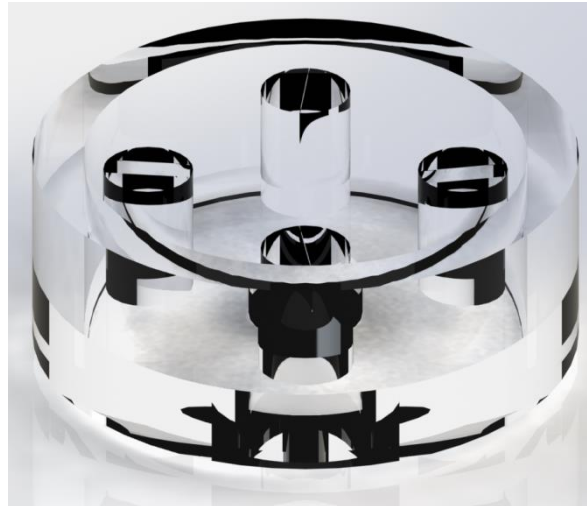
FIG. 108 : Dispositif bi-axial en silice permettant d'enrouler 20 m de fibre sur un diamètre de 12 cm.
