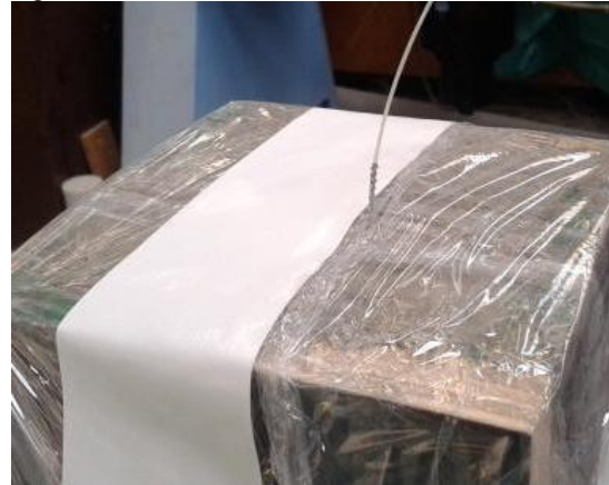
FIG. 72 : (a) Maintien manuel de la fibre sous tension lors du coulage et (b) poutre coulée enrobée de cellophane pour le séchage.
