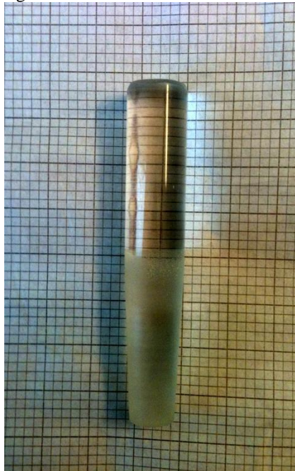
FIG. 88 : Installation de la première version des tiges de silice. FIG. (a) Tige de 8 cm, celles utilisées font 12 cm. (b) Trous creusés au rodoir diamanté. (c) Tiges installées, 8 cm restant à l'extérieur de la roche.
