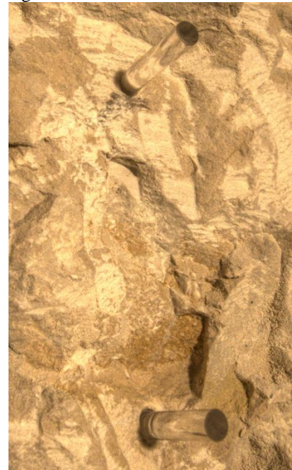
FIG. 88 : Installation de la première version des tiges de silice. FIG. (a) Tige de 8 cm, celles utilisées font 12 cm. (b) Trous creusés au rodoir diamanté. (c) Tiges installées, 8 cm restant à l'extérieur de la roche.
