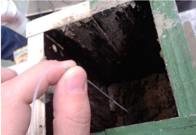
FIG. 72 : (a) Maintien manuel de la fibre sous tension lors du coulage et (b) poutre coulée enrobée de cellophane pour le séchage.
