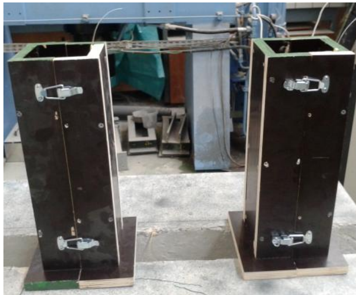
FIG. 70 : Coffrage des poutres pour l'expérience de microdéformation réalisée par Véronique Mary.
