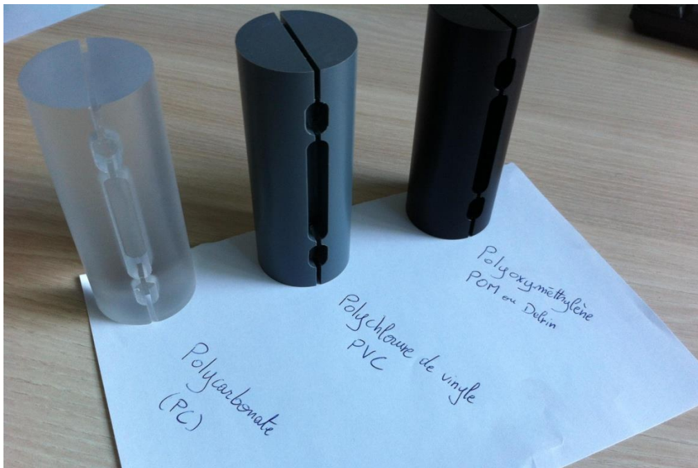
FIG. 75 : Différentes éprouvettes réalisées en PC, PVC et Delarin (de gauche à droite).
