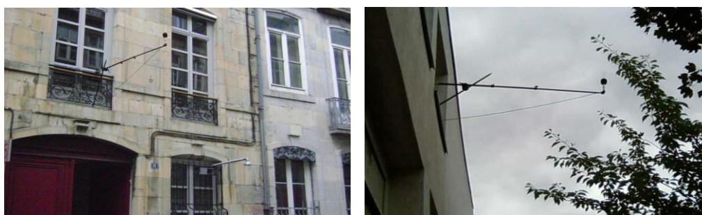
Figure 6: Microphones installés en façade de bâtiments pour l'estimation de l'exposition au bruit environnemental. Crédit photo Quentin Tenailleau.
