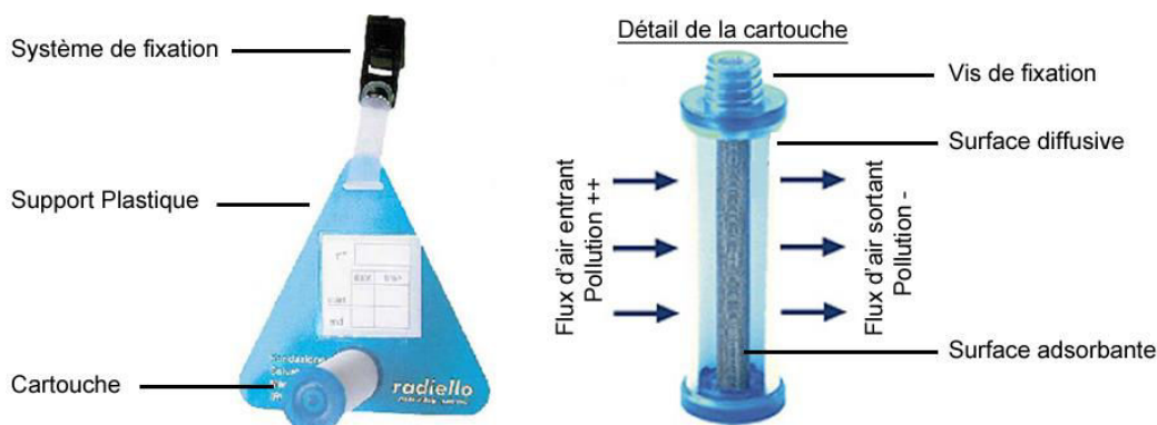
Figure 9: Exemple d'échantillonneur passif à NO 2 de marque Radiello et détail de son fonctionnement.
