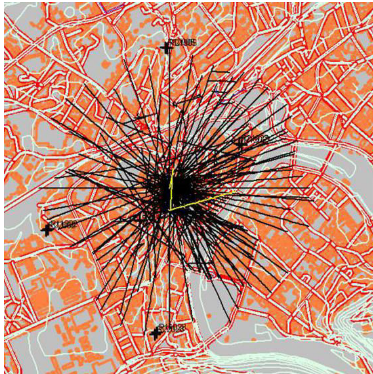
Figure 14: Exemple de rayons reliant un point récepteur et l'ensemble des sources situées dans un rayon de 1km, d'après (Pujol, 2012)
