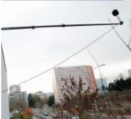
Quentin Tenailleau installe des micros pour réaliser les enregistrements sonores sur les sites où l'association ATMO-FC effectue des mesures de polluants : ozone et oxydes d'azote (NOx). Il analyse leur évolution conjointe toutes les 10 secondes.
