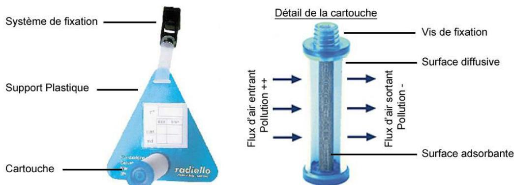
**Figure 9:** Exemple d'échantillonneur passif à NO<sub>2</sub> de marque Radiello et détail de son fonctionnement.
