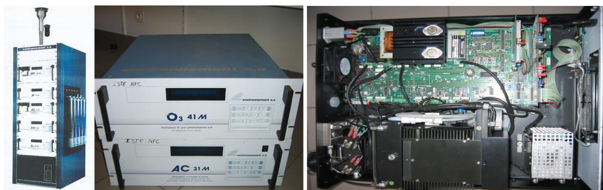
Figure 10: Station de mesure fixe avec analyseurs de PM, de NO x , de CO et d'O 3 . Détail des analyseurs NO x par chimiluminescence (AC 31M) et d'ozone par absorption dans l'UV (O 3 41M), et vue interne d'un analyseur NO x par chimiluminescence (AC 31M). Crédit Photo Nadine Bernard.
