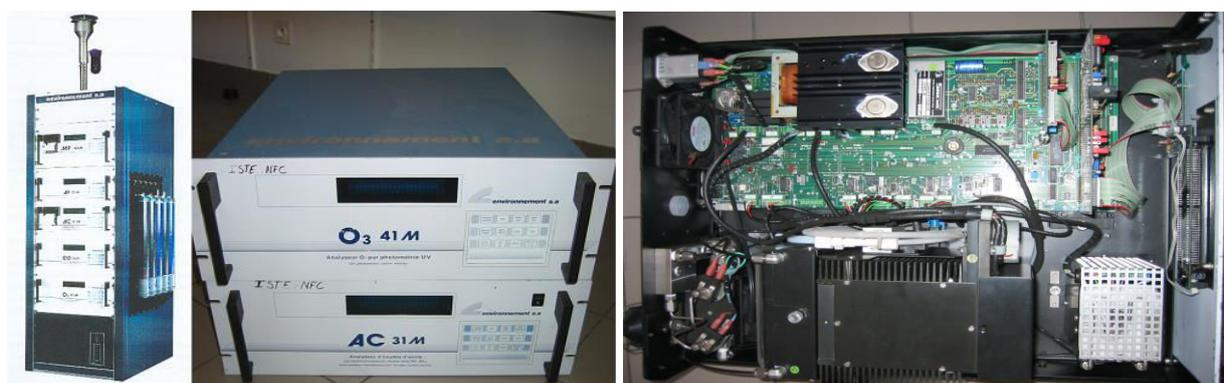
**Figure 10:** Station de mesure fixe avec analyseurs de PM, de NO<sub>x</sub>, de CO et d'O<sub>3</sub>. Détail des analyseurs NO<sub>x</sub> par chimiluminescence (AC 31M) et d'ozone par absorption dans l'UV (O<sub>3</sub> 41M), et vue interne d'un analyseur NO<sub>x</sub> par chimiluminescence (AC 31M). Crédit Photo Nadine Bernard.
