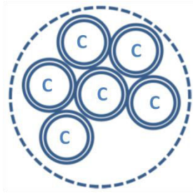
Figure 17 : Agencement des 6 fibres collectrices (C) en sortie du bundle et qui est mis en regard de la face d'entrée du spectromètre
