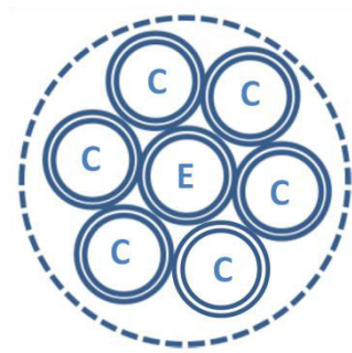
Figure 11 : dessin du bundle de fibre, (E) fibre excitatrice, (C) fibres collectrices
