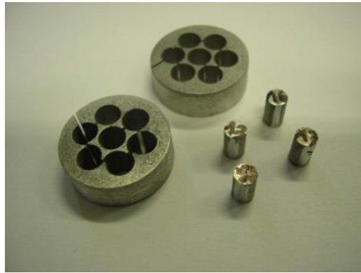
Figure A.1: Eprouvettes cylindrique de compression de diamètre 3 mm et de hauteur 5 mm préparées par électroérosion.
