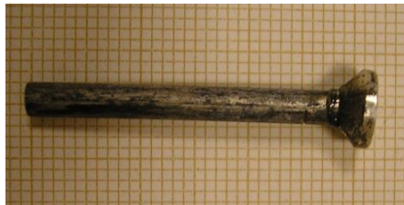
Figure B. 1: Exemple d'échantillon obtenu par extrusion à 350°C – vitesse=0.9 mm/min
