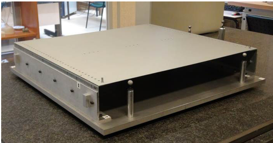
Figure 5.51 – Couvercle mis en position sur l'ensemble support (phase n°1)
