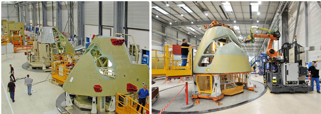
Figure 1.6 – Atelier d'assemblage de la pointe avant d'un Airbus A380 (images Aerolia).
