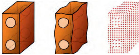
Figure 2.12 – Illustration du modèle nominal CAO, d'un Skin model continu et d'un Skin model shape discret [Anwer et al. , 2013].
