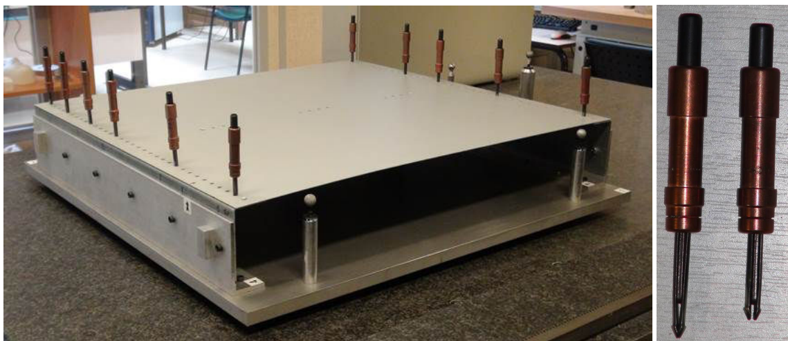
Figure 5.52 – Couvercle pré-assemblé sur l'ensemble support (phase n°2)
