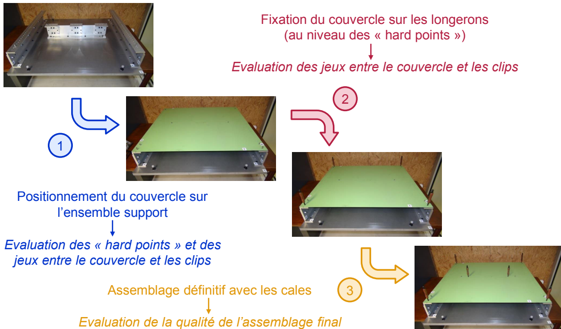
Figure 5.5 – Scénario d'assemblage mis en œuvre sur le support expérimental.
