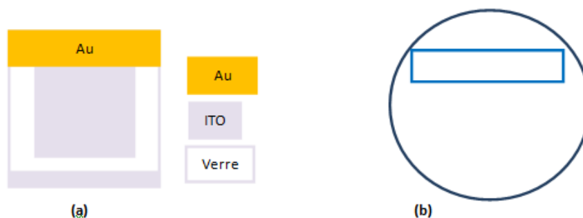
Figure 3 : (a) Schéma de dépôt de la bande d'or d'une épaisseur de 60 nm sur substrat gravé d'ITO
