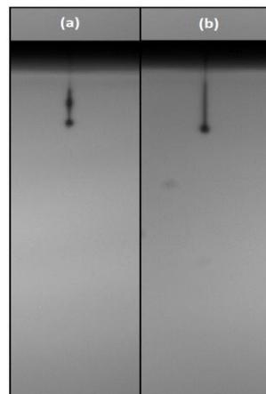
Figure 1.2.2 : **(a)** Problème d'éjection : goutte avec des satellites
