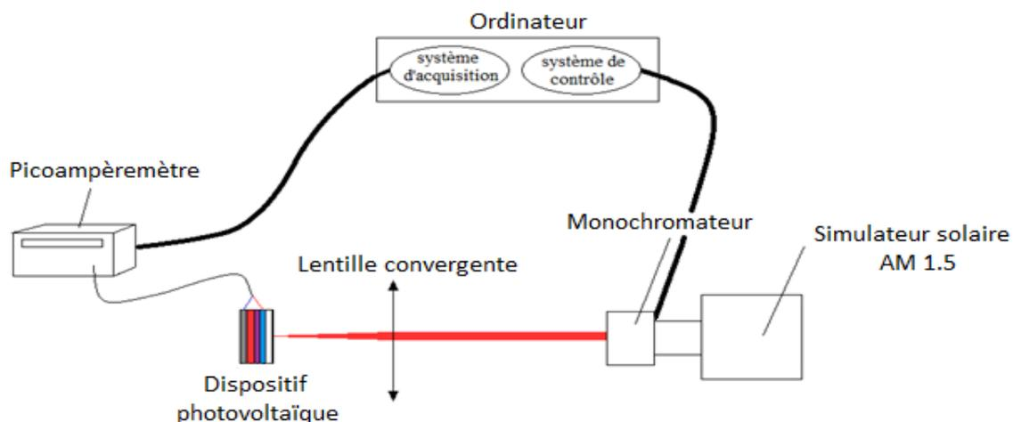
Figure 3.3.1 : Schéma du dispositif de mesure de l'IPCE
