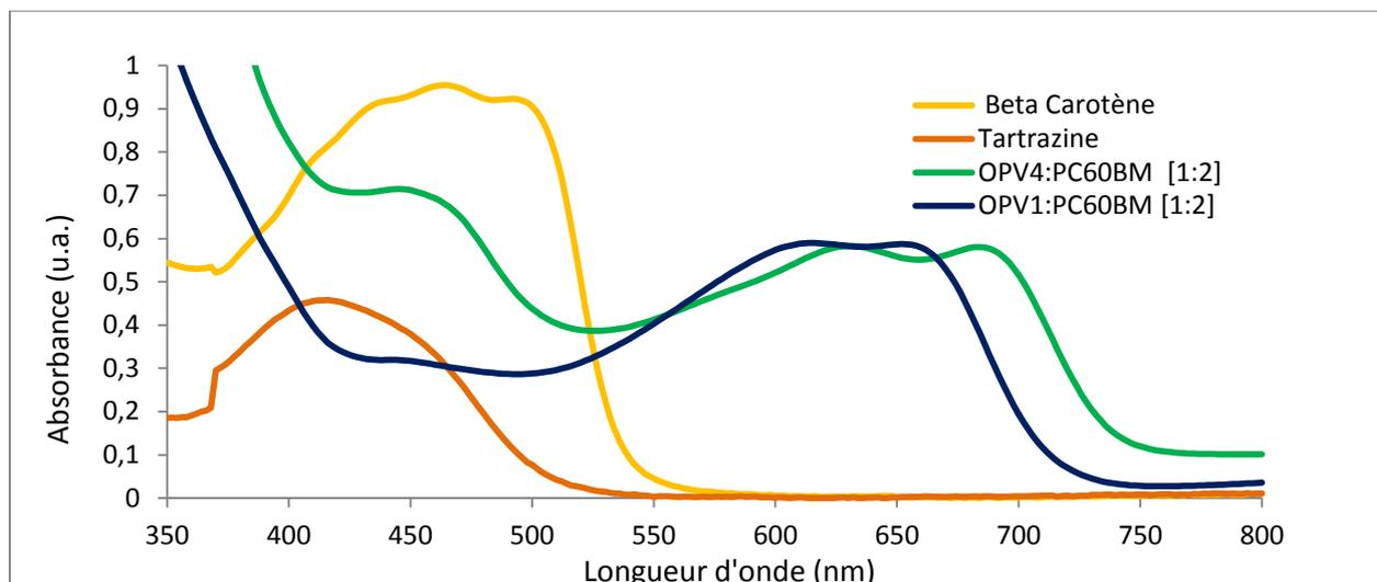
Figure 3.1.3 : Spectres d'absorption des pigments adaptés au filtrage des cellules à base d'OPV1:PC<sub>60</sub>BM et d'OPV4:PC<sub>60</sub>BM
