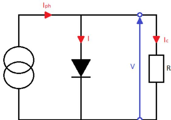
Figure 3.2.2 : Schéma équivalent d'une cellule photovoltaïque idéale
