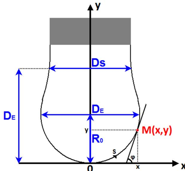
Figure 2.1.1: Définition du système utilisé pour la technique de la goutte pendante ([retour](#))
