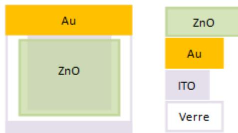
Figure 4 : Schéma de dépôt du ZnO nanoparticules
