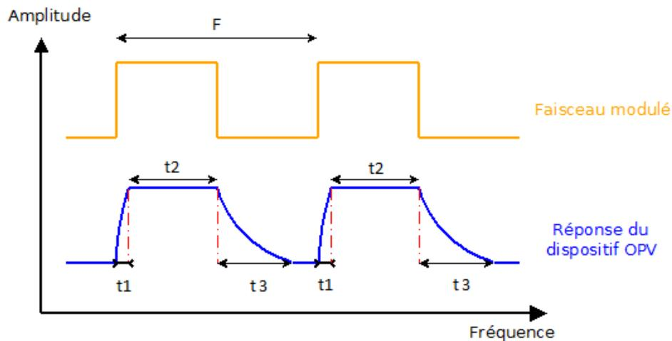
Figure 2.3.6 : Impact de la modulation sur la réponse du dispositif OPV
