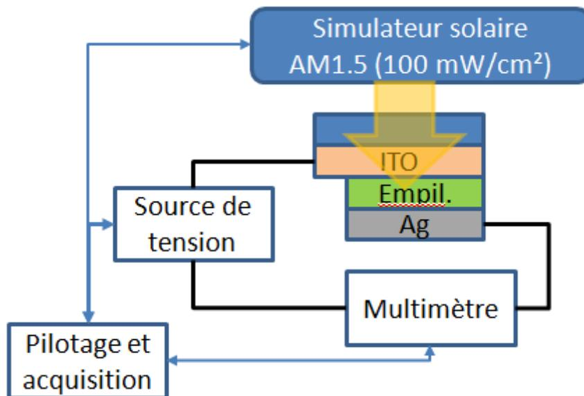
Figure 3.2.1 : Schéma du dispositif de mesure I(V) et
