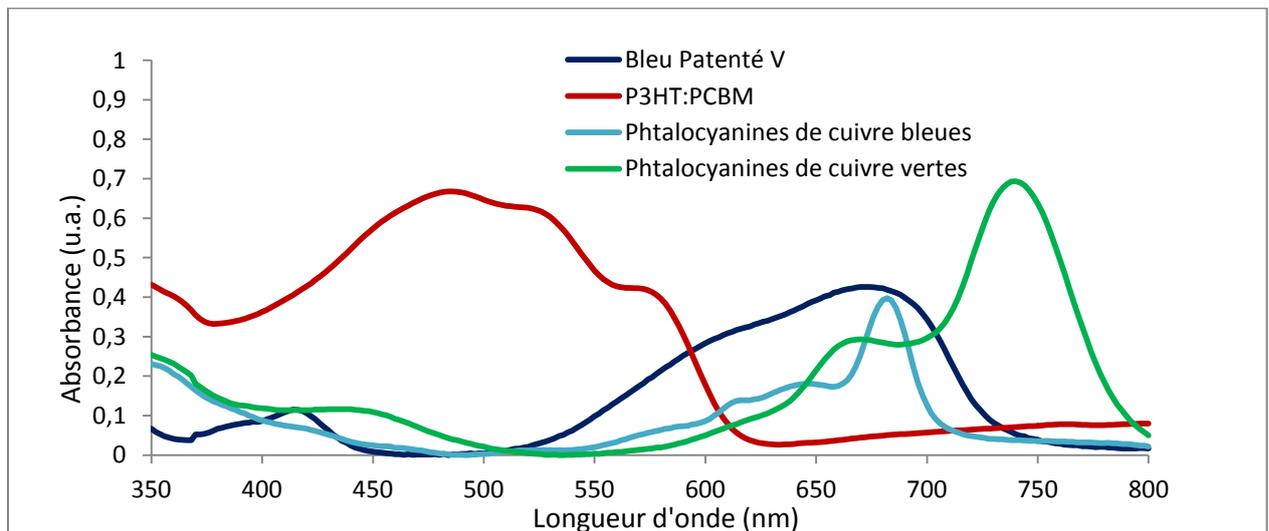
Figure 3.1.2 : Spectres d'absorption des pigments adaptés au filtrage des cellules à base de P3HT:PC<sub>60</sub>BM
