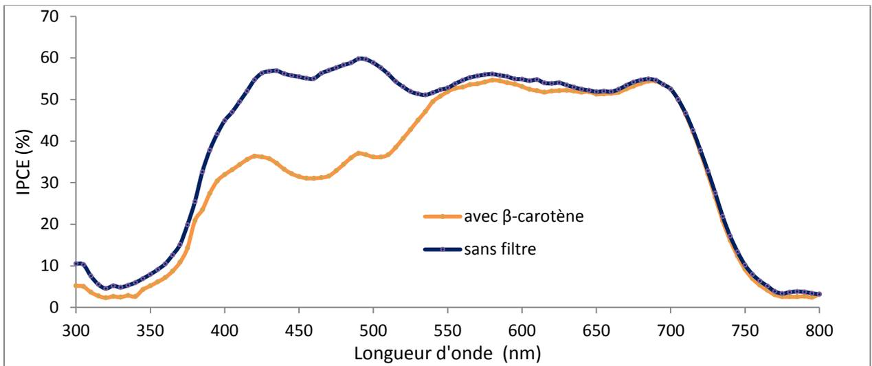
Figure 3.4.2 : IPCE du dispositif avec et sans filtre
