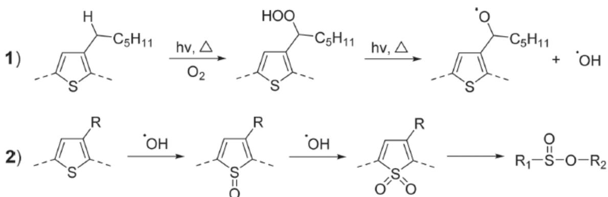
Figure 4.1.4 : Mécanismes de photo-oxydation du P3HT proposés par Manceau & al. :
