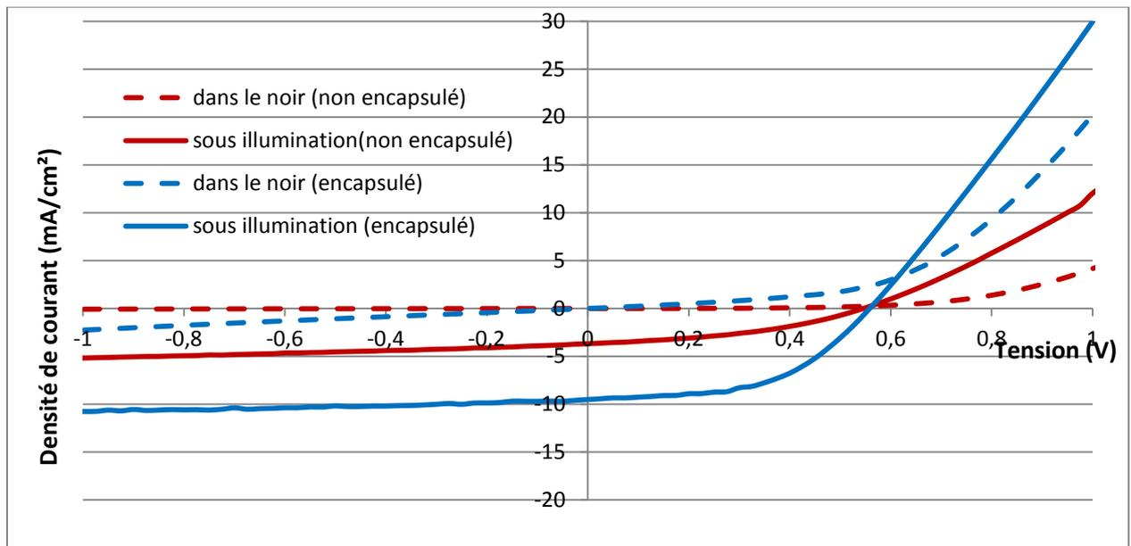
Figure 3.2.5 : Paramètres photovoltaïques et courbes  $J(V)$  des cellules auto-encapsulée et non encapsulée après vieillissement
