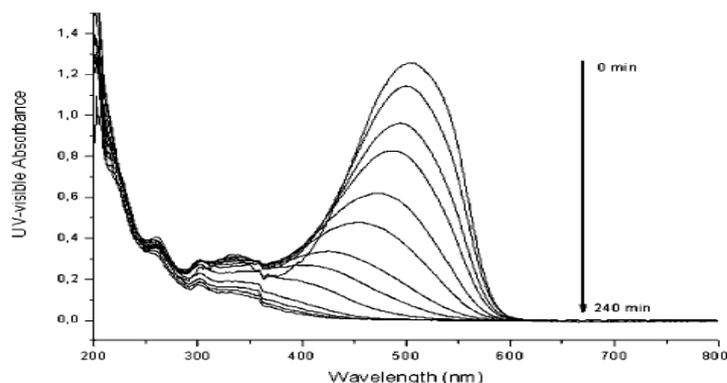
Figure 4.1.1 : Evolution du spectre d'un film de MDMO-PPV soumis à une atmosphère ambiante pendant 4 h sous une illumination ( $\lambda > 300$  nm) [72]
