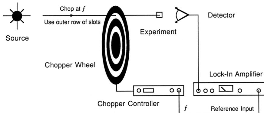
Figure 2.1.5 : Principe de la détection synchrone [51]
