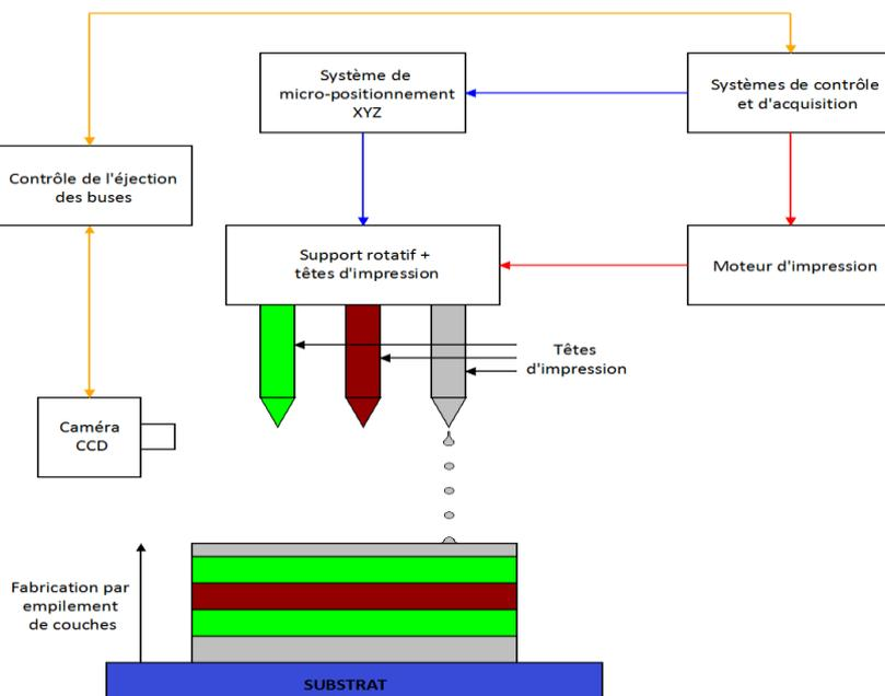
Figure 1.2.1 : Procédé d'impression par jet d'encre
