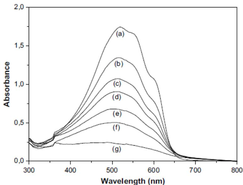
Figure 4.1.3 : Evolution du spectre UV/visible d'un film de P3HT soumis à une atmosphère ambiante sous une illumination ( $\lambda > 300$  nm) et à une température de  $60^\circ\text{C}$  (a) 0 h, (b) 15 h, (c) 30 h, (d) 40 h, (e) 50 h, (f) 60 h, et (g) 80 h. [75]
