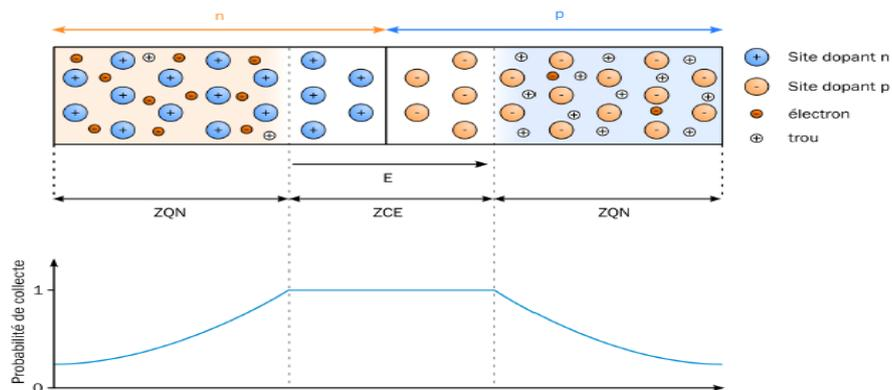
Figure 2.1.1 : Représentation du champ électrique dans une jonction p-n et probabilité de collecte [16]
