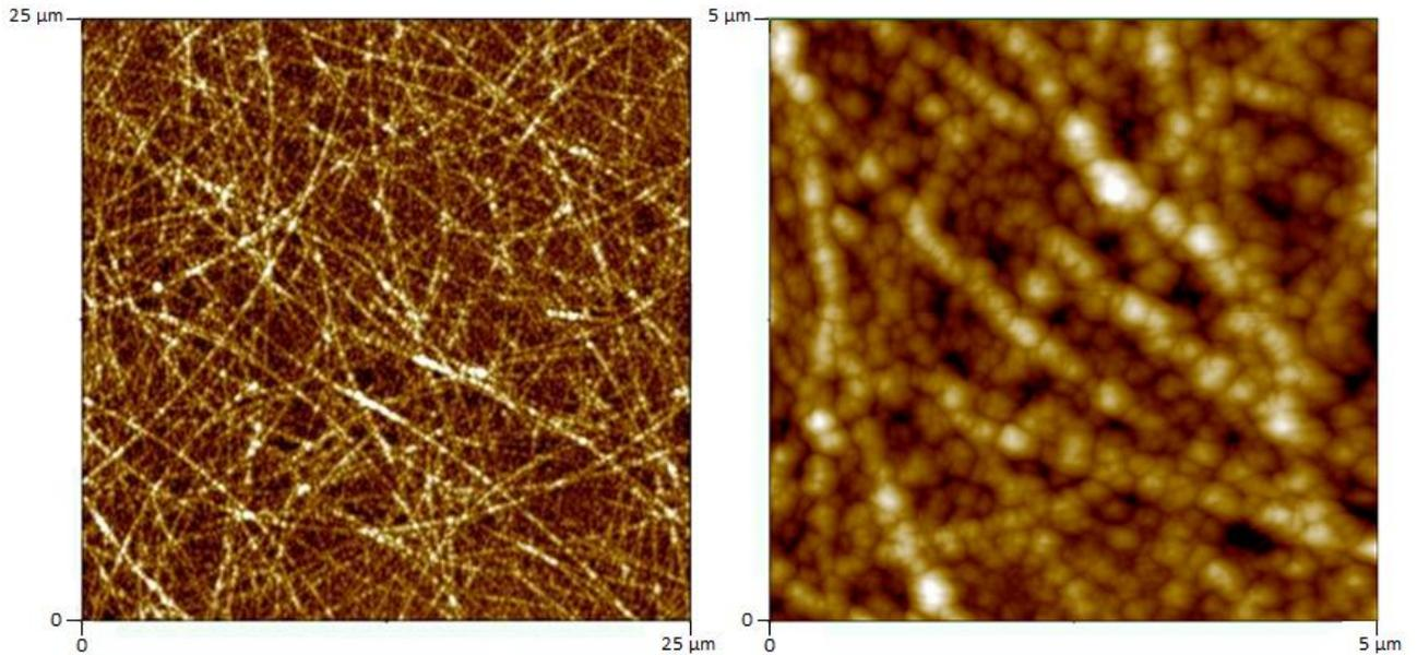
Figure 3.5.3 : Cartographies AFM : Verre/AgNWs/ZnO à différentes échelles
