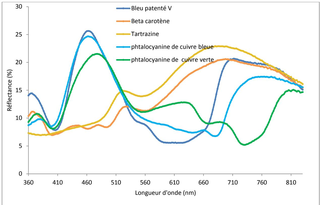
Figure 3.3.1 : Spectres de réflexion des 5 pigments sélectionnés
