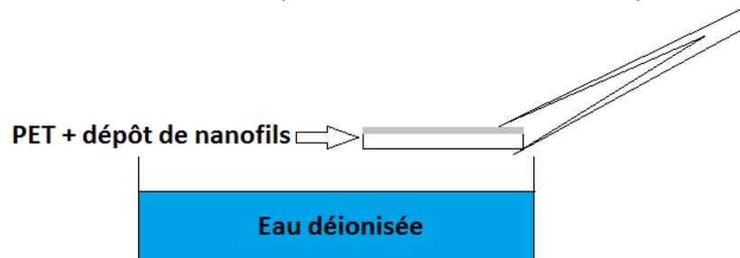
Figure 4 : Lavage du dépôt de nanofibres
