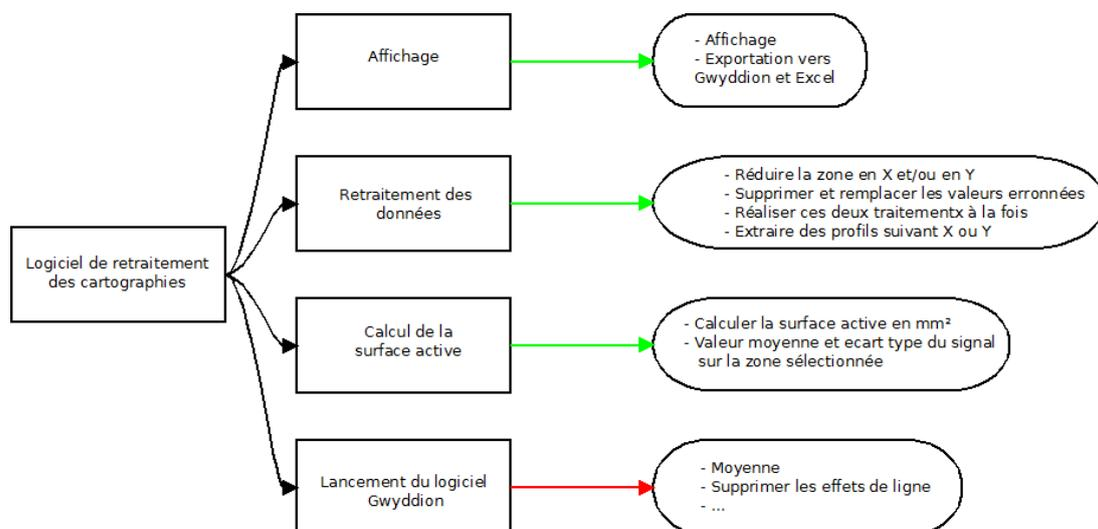
Figure 2.2.4 : Logiciel de retraitement (— développé au sein du laboratoire et — externe au laboratoire)
