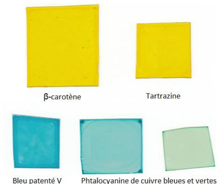
*Figure 3.2.2 : Exemple de dépôts de pigment effectués à la tournette sur substrat PET > 1 cm<sup>2</sup>*
