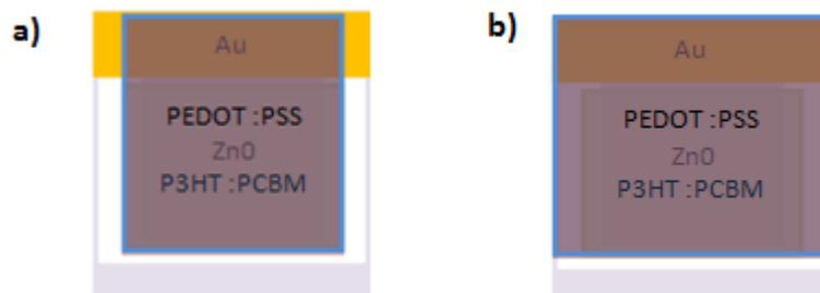
Figure 6 : **(a)** Gravure dans le cas du design encapsulant, **(b)** Gravure dans le cas du design non encapsulant
