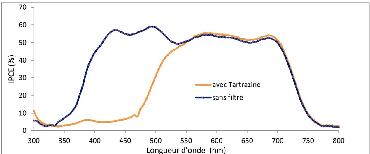
Figure 3.4.5 : IPCE du dispositif avec et sans filtre
