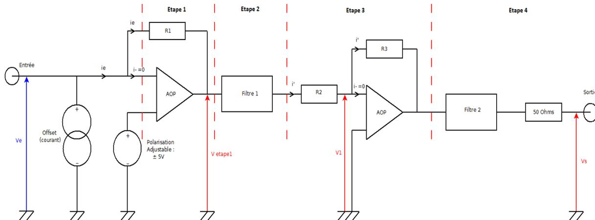
Figure 2.1.4 : Schéma Bloc du préamplificateur SR 570
