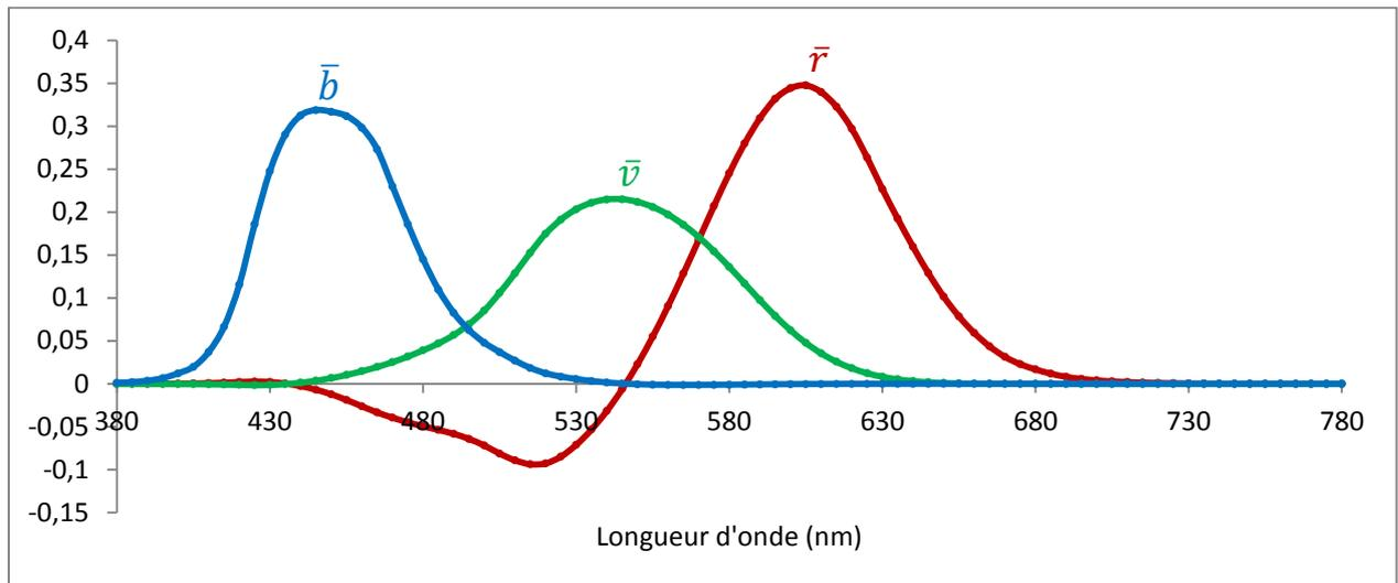
Figure 2.3.2 : Fonctions colorimétriques  $\bar{r}$ ,  $\bar{v}$  et  $\bar{b}$
