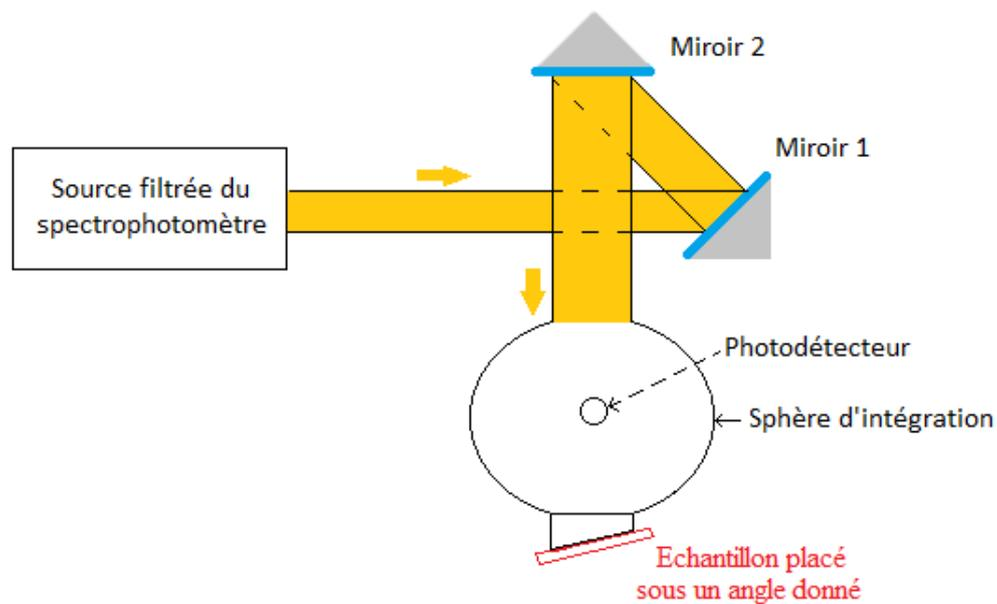
Figure 2.5.1 : Schéma de fonctionnement du spectrophotomètre par réflexion
