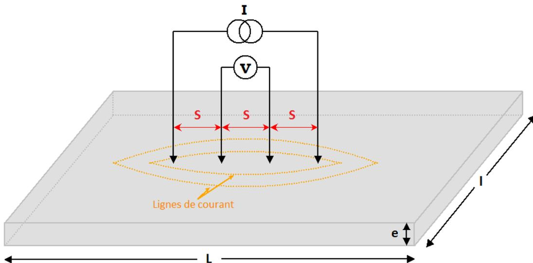
Figure 2.3.2 : Schéma du principe de la mesure 4 pointes
