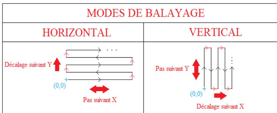
Figure 2.2.1: Mode de balayage de la platine XY
