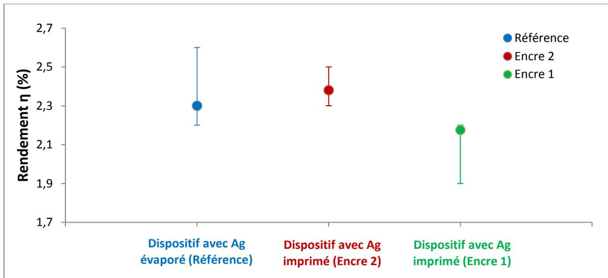
Figure 2.5.4 : Comparaison des performances de dispositifs à base d'ETL 2 pour différentes électrodes supérieures
