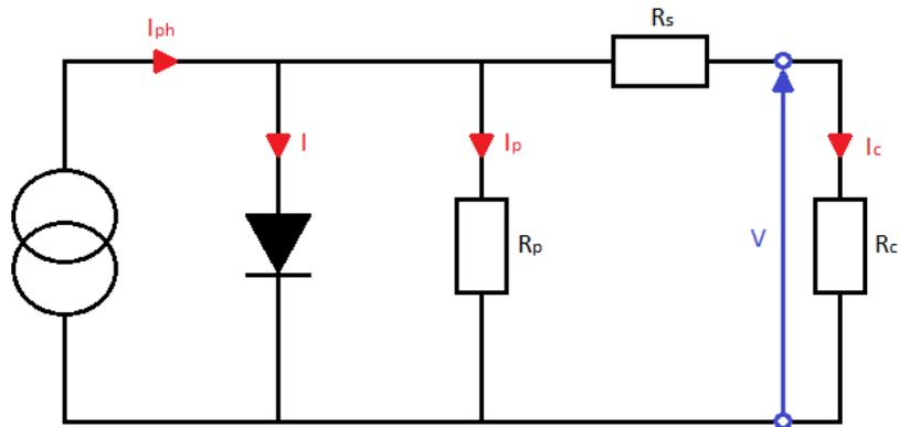
Figure 3.2.3 : Schéma équivalent d'une cellule photovoltaïque
