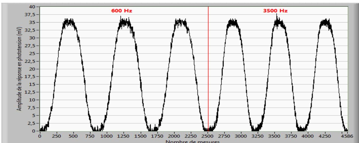
*Figure 2.3.12 : Réponse d'une cellule de 1cm<sup>2</sup> en circuit ouvert pour des fréquences de modulation de 600 et 3500 Hz*
