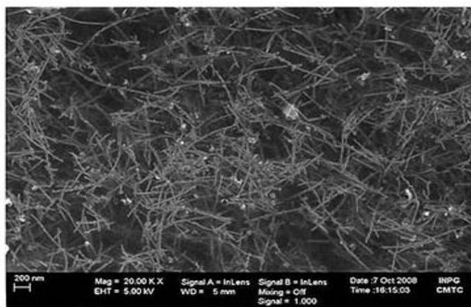
Figure 3.3.11 : Dépôt de nanotubes de carbone (cartographie MEB transmis par le fournisseur)
