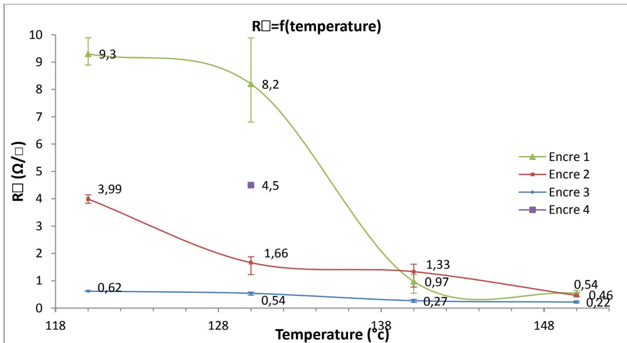
Figure 2.3.3 :  $R_{\square} = f(T^{\circ})$  pour les 4 encres d'argent
