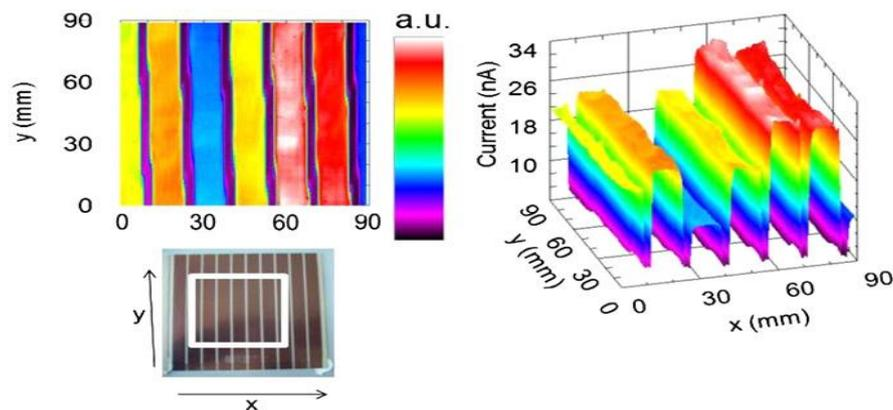
Figure 1.3.6 : Cartographie LBIC d'une portion d'un module Konarka [46]
