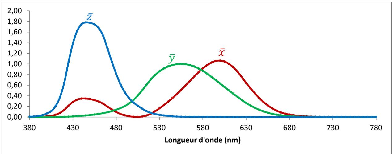
Figure 2.3.3 : Fonctions colorimétriques  $\bar{x}$ ,  $\bar{y}$  et  $\bar{z}$  (CIE 1931) [39]
