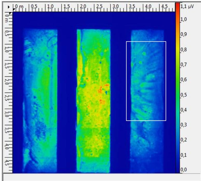
Figure 3 : Cartographie LBIV d'un module OPV
