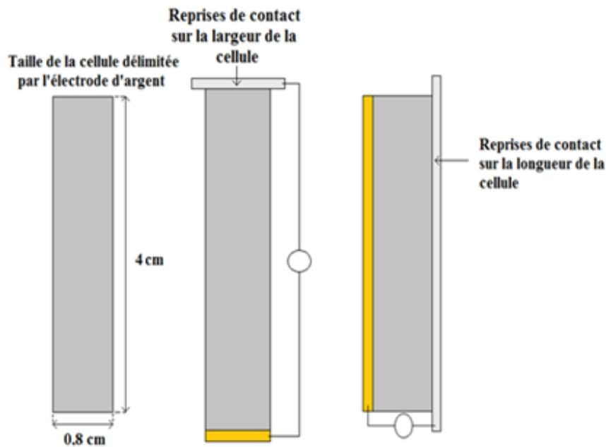
Figure 2.3.13 : Schéma du positionnement des reprises de contact
