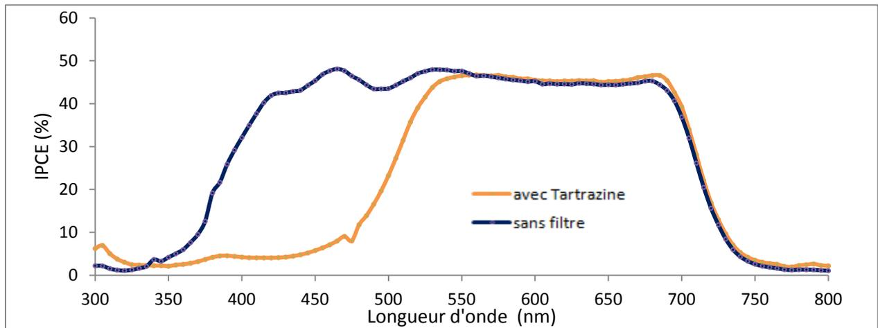
Figure 3.4.9 : Performances et IPCE du dispositif à base d'OPV 1:PC<sub>60</sub>BM avec et sans tartrazine
