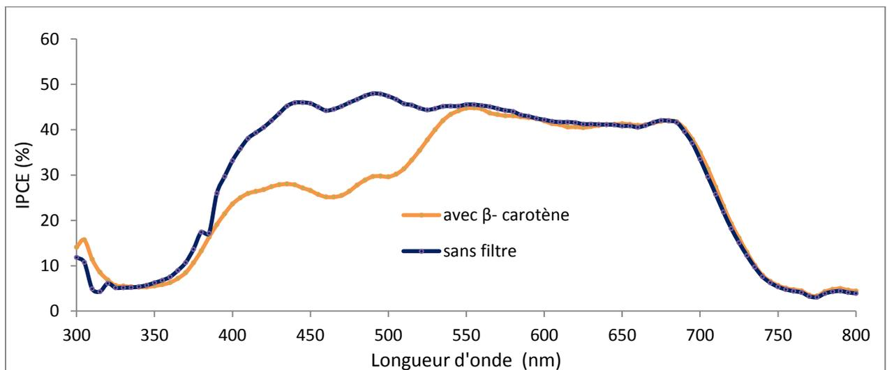
Figure 3.4.7 : Performances et IPCE du dispositif à base d'OPV 1:PC<sub>60</sub>BM avec et sans  $\beta$ -carotène
