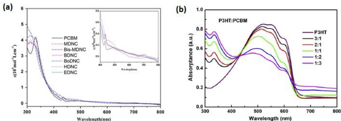
Figure 1.1.6 : Spectres d'absorption de différents dérivés de C<sub>60</sub> [22] et suivant le ratio de P3HT:PCBM [23]
