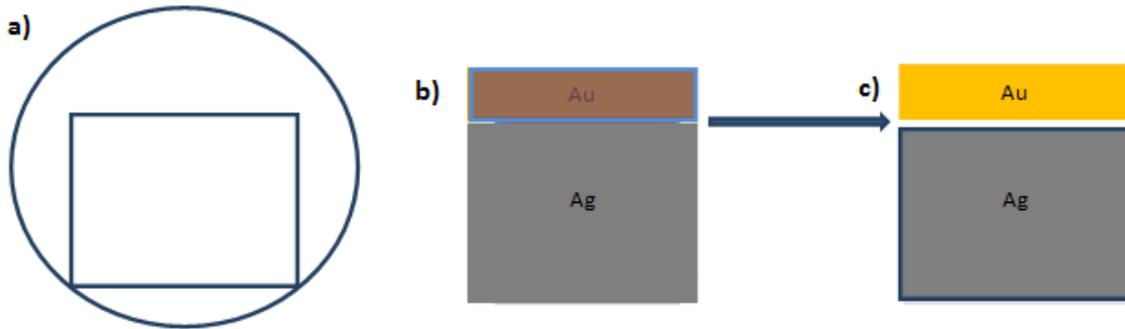
Figure 6 : **(a)** Masque pour le dépôt d'Ag, **(b)** Dépôt de l'anode en argent, **(c)** Gravure du PEDOT:PSS et du P3HT:PCBM
