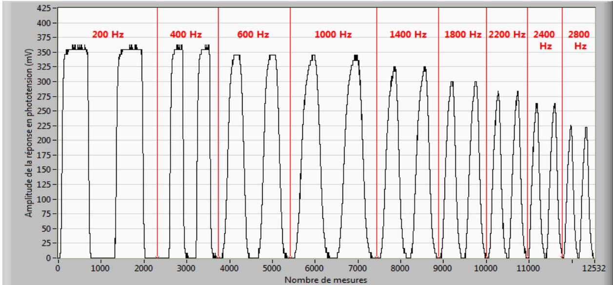
*Figure 2.3.11 : Réponse de la cellule de 2cm<sup>2</sup> en circuit ouvert pour différentes fréquences de modulation*
