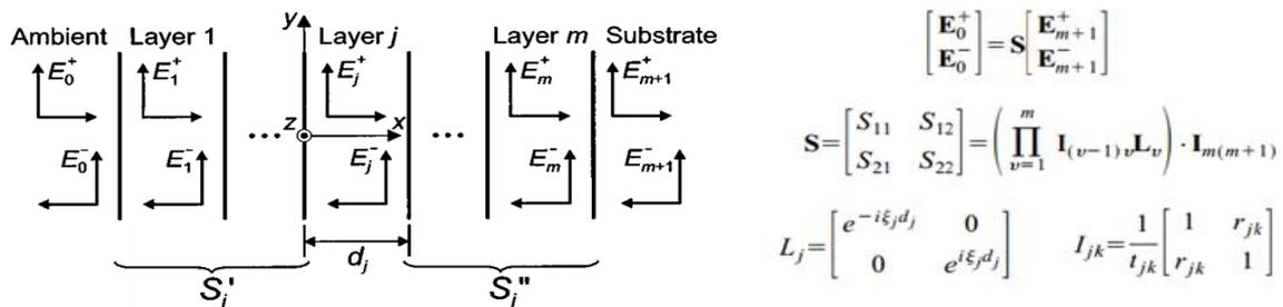
Figure 4.1.3 : Principe du calcul matriciel utilisé pour calculer le spectre de réflexion
