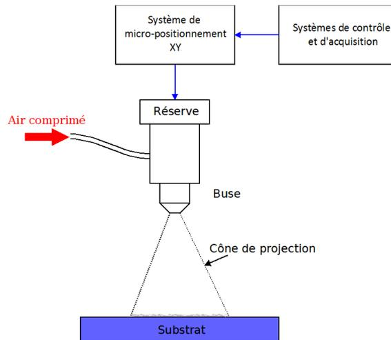
Figure 3.3.2 : Schéma d'un dispositif standard de spray coating
