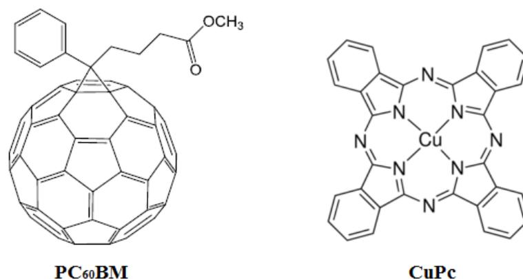
Figure 2.3.4 : Structures de petites molécules couramment utilisées dans les cellules solaires organiques
