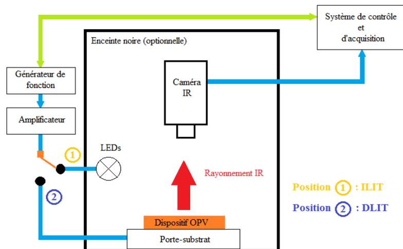
Figure 1.2.2 : Schéma du dispositif de thermographie par verrouillage en fréquence [20]
