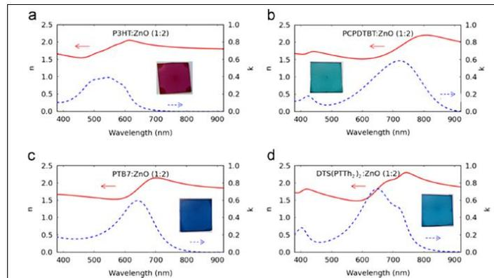
Figure 1.1.5 : Indices de réflexion  $n$  et  $k$  des différents dépôts ainsi que la couleur résultante [18]
