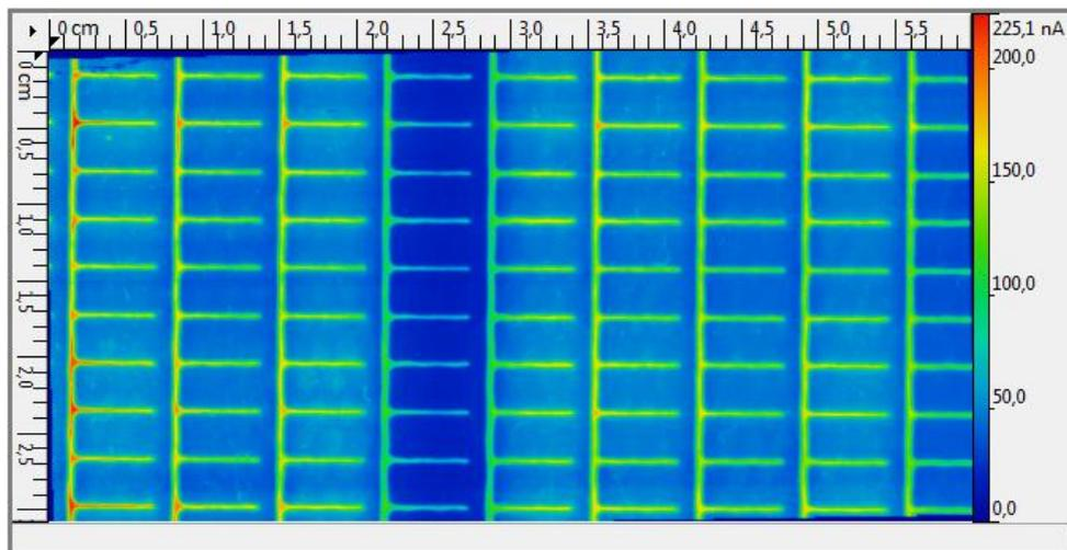
Figure 1 : Cartographie LBIC d'une portion d'un module CIGS
