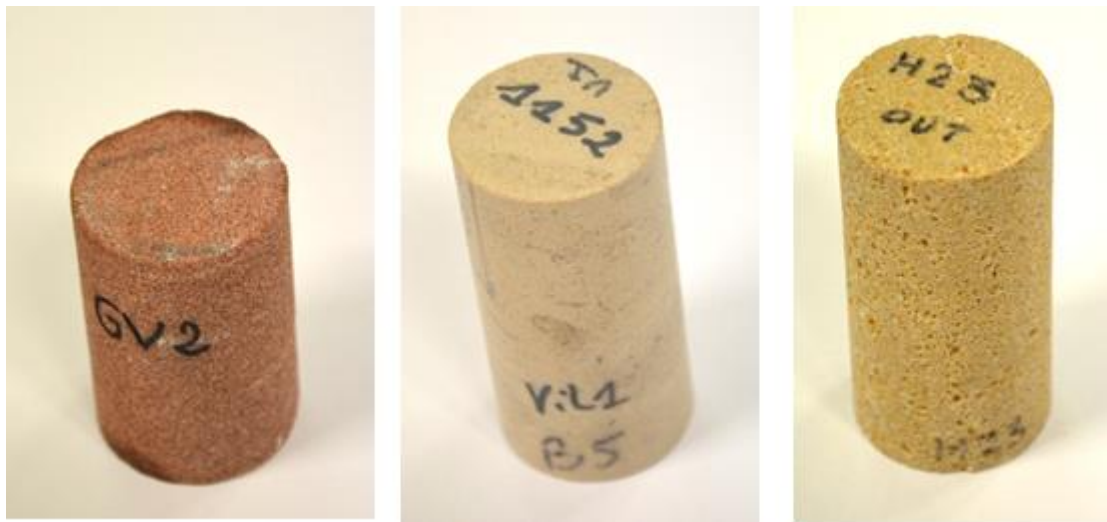
Figure 48: Les échantillons de roche cylindriques sur lesquels sont faites les mesures. De gauche à droite : grès des Vosges (diamètre D=4\text{cm} , longueur L=6\text{cm} ), calcaire de Vilhonneur (diamètre D=4\text{cm} , longueur L=8\text{cm} ), et calcaire d'Euville (diamètre D=4\text{cm} et longueur L=8\text{cm} ).
