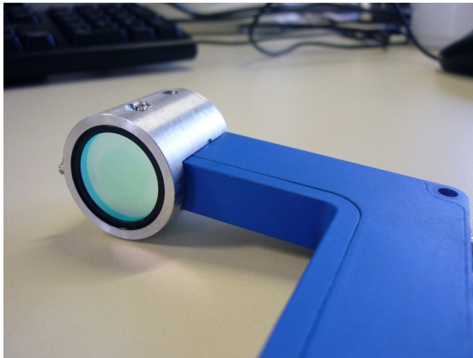
FIGURE 3.19 – Un filtre optique passe bande centré sur la longueur d'onde des fourches optiques Wenglor (655 nm) et avec un coefficient de transmission supérieur à 93 %.
