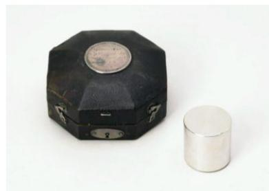
Figure 8 - *Étalon prototype du kilogramme avec son étui*, fabriqué par Nicolas Fortin, platine, 1799
