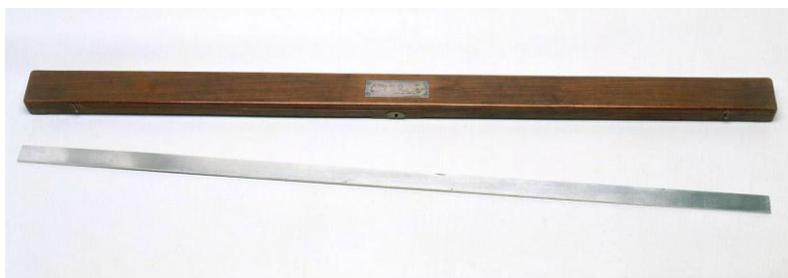
Figure 7 – *Étalon prototype du mètre avec son étui*, fabriqué par Étienne Lenoir, platine, 1799
