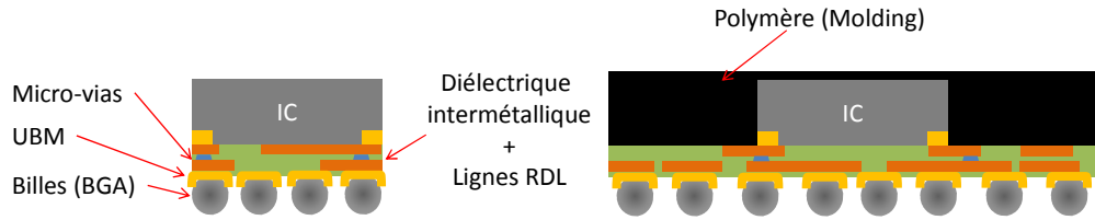
Figure I-21 Comparaison des configurations Fan-In (a) et Fan-Out ou eWLB (b)
