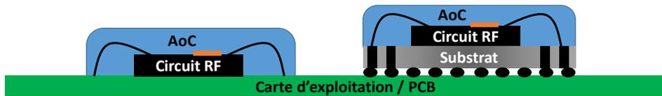
Figure I-14 Exemples de scénarios d'intégration de modules RF avec antennes AoC
