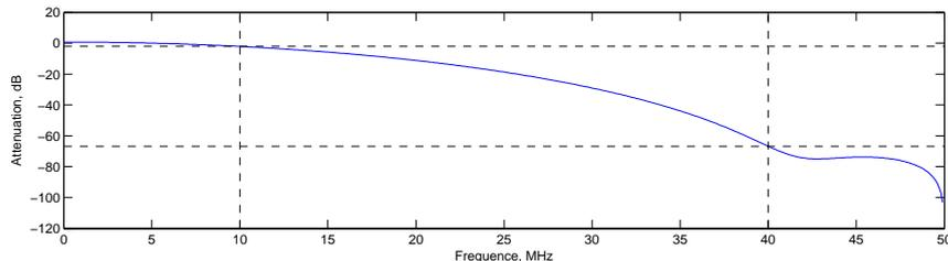
FIGURE 4.13 – Filtre d'entrée d'ordre 10 pour l'élimination des fréquences supradynes.
