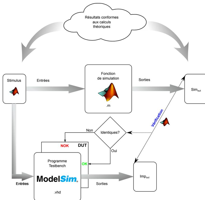
FIGURE C.10 – Méthodologie de vérification simulation-implantation.
