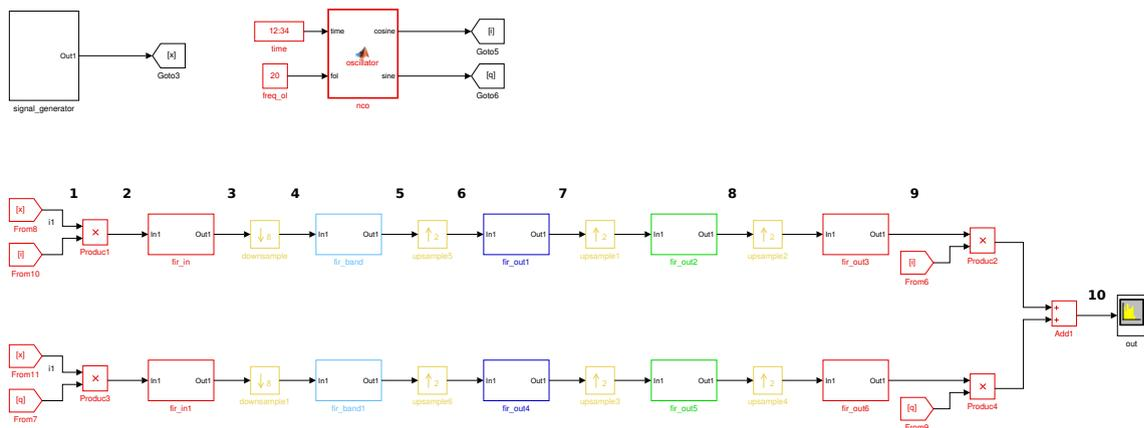
FIGURE 4.20 – Schématique SIMULINK® du filtrage débit-multiple.
