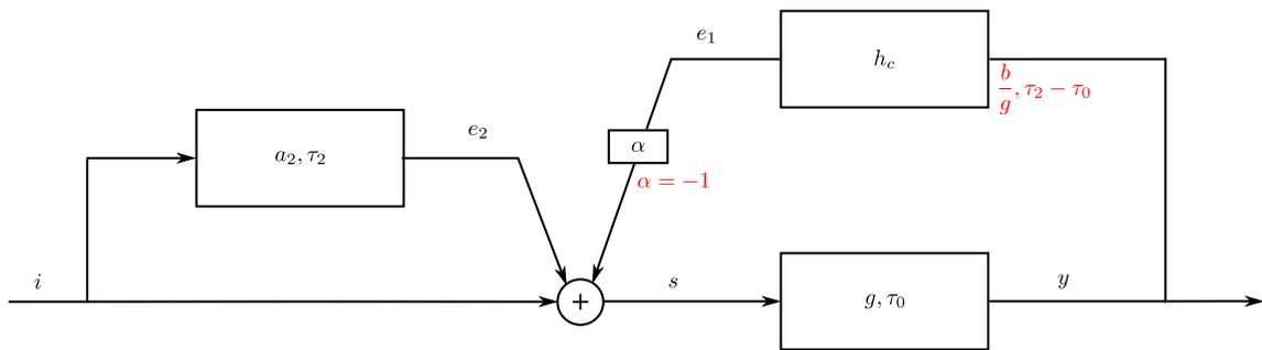
FIGURE 2.9 – Compensation par contre-réaction de l’effet d’un émetteur parasite.
