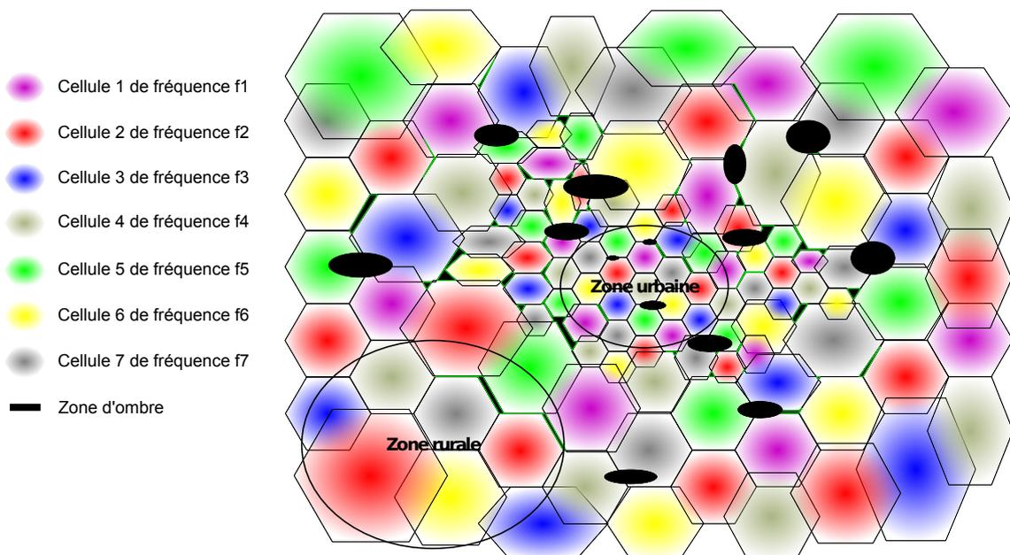
FIGURE 1.7 – Concept cellulaire de la couverture radio-fréquence.
