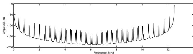
un sur-échantillonnage par 2. Des fréquences images sont créées dans la bande [6.25, 12.5] MHz. Comme nous l'avons expliqué dans le paragraphe 4.2.5.2, un sur-échantillonnage progressif, par 2, suivi d'un filtrage est beaucoup plus avantageux qu'un sur-échantillonnage par 8 suivi d'un filtrage.
