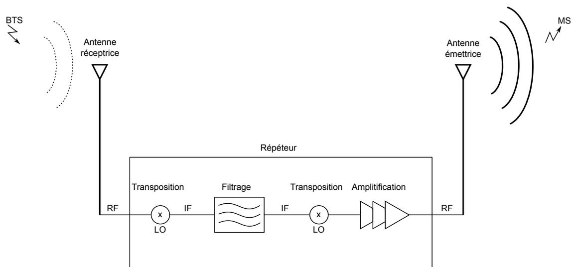
FIGURE 1.8 – Synoptique simplifié d'un répéteur iso-fréquence.
