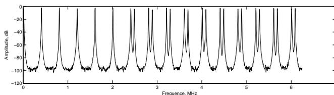
La nouvelle limite de SHANNON est de 6.25 MHz. La figure ci-contre le montre et confirme effectivement que la bande  $[0, 2.5]$  MHz est une bande préservée, c'est-à-dire qu'elle n'a subi aucun repliement.
