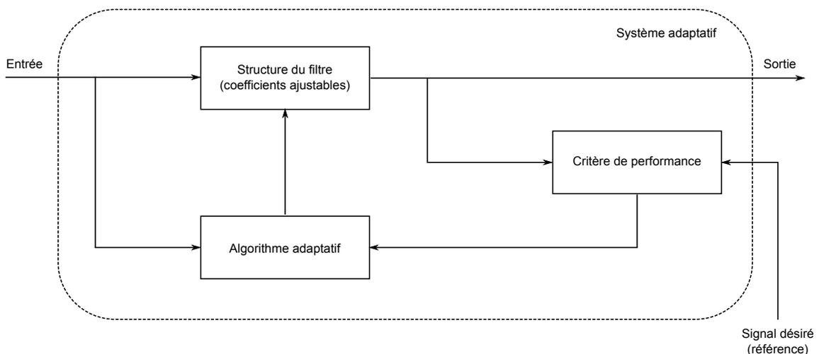
FIGURE 3.1 – Modèle général d'un filtre adaptatif.
