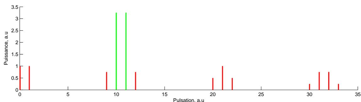
FIGURE 7.10 – Spectre en sortie d'un amplificateur non linéaire.
