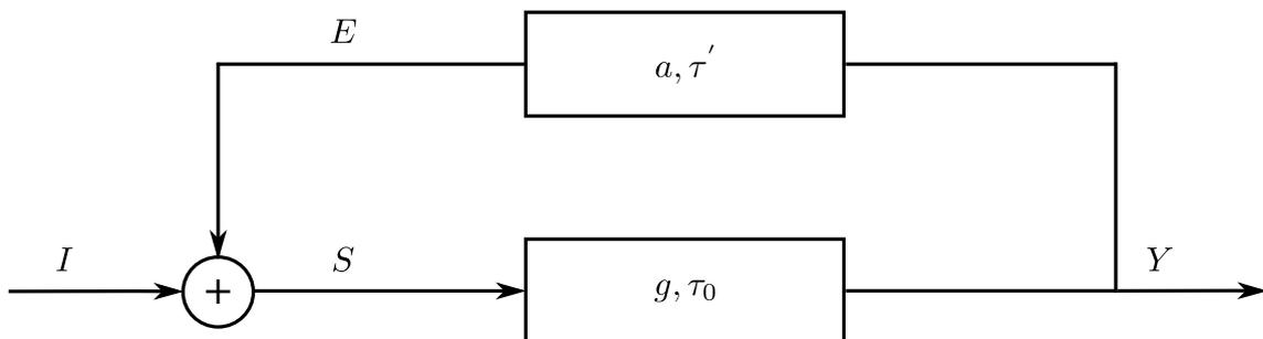
FIGURE 2.3 – Paramètres et configuration de l'écho direct.
