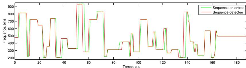
FIGURE 4.26 – Comparaison des séquences d'entrée et de sortie, capacité de poursuite des sauts de fréquence à 1 ms.
