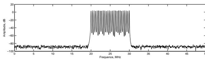
quence d'échantillonnage  $f_s = 50$  MHz suffit pour les atténuer d'au moins 50 dB.
