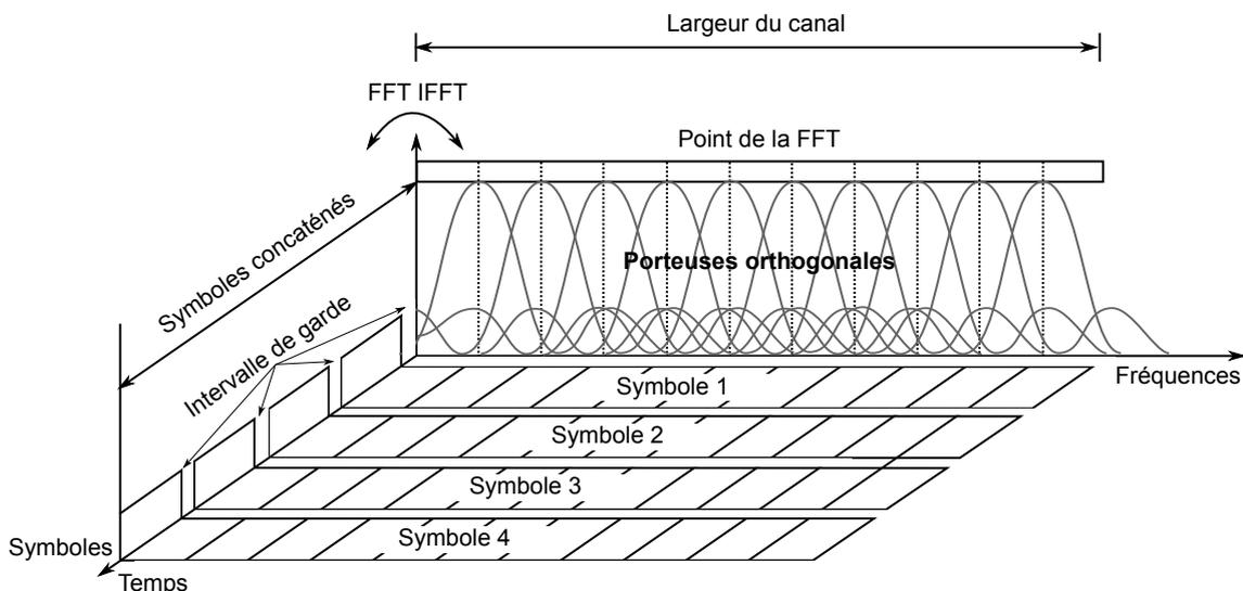
FIGURE 1.4 – Représentation temps-fréquence d'un signal OFDM.
