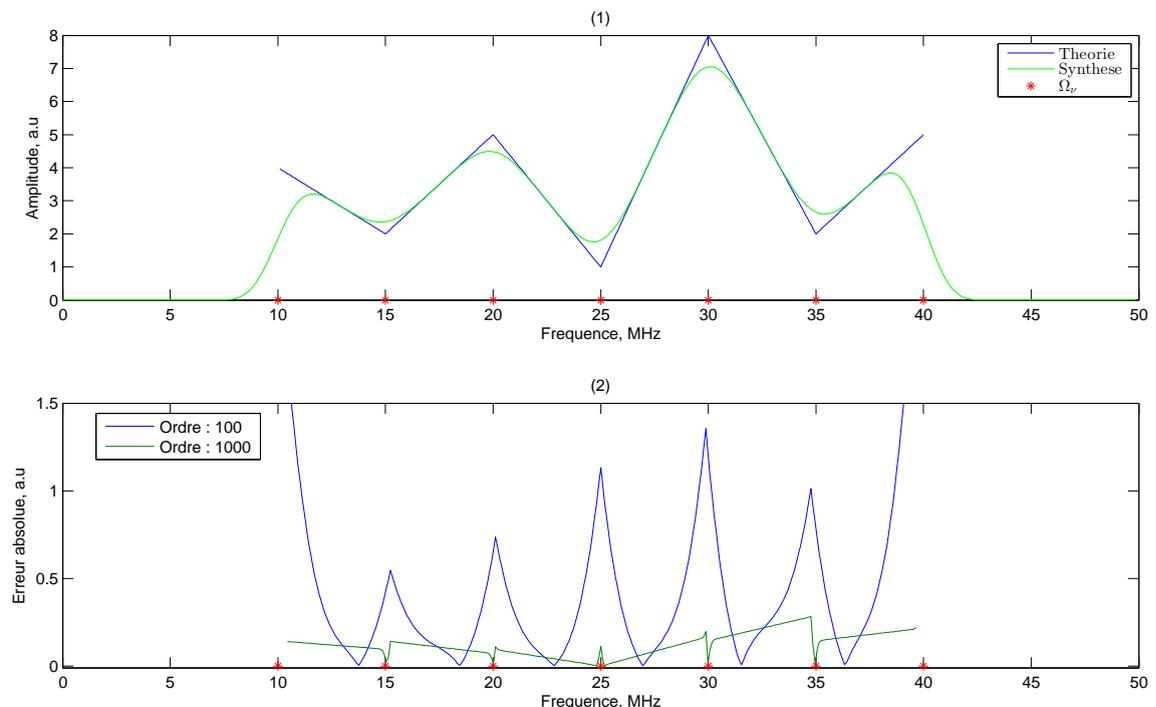
FIGURE 5.3 – Pré-distorsion en amplitude par interpolation linéaire.
