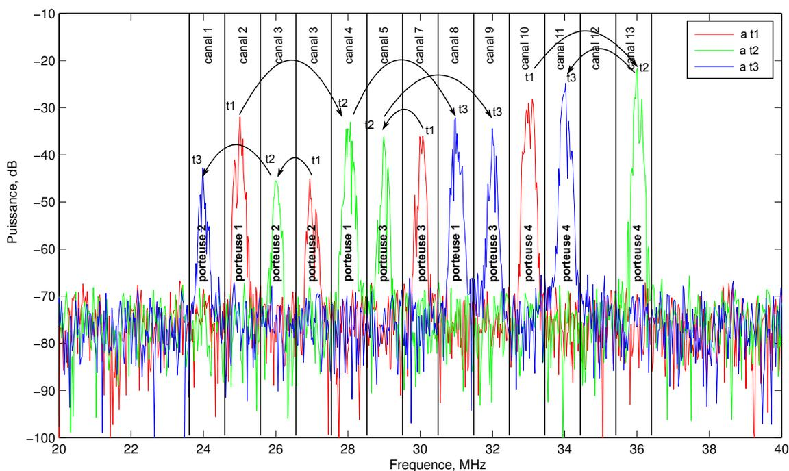
FIGURE 4.2 – Exemple de sauts de fréquence.
