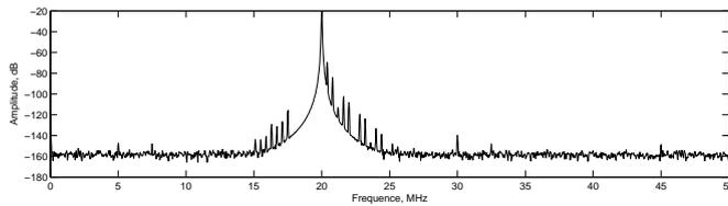
cent est ainsi atténué de 50 dB. On note une baisse du niveau du signal, cela est dû au sur-échantillonnage et à l'insertion des zéros. Cette baisse peut se compenser par une simple amplification.
