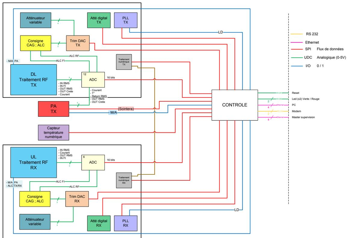
FIGURE 6.3 – Synoptique du système de contrôle du DigiRep®.
