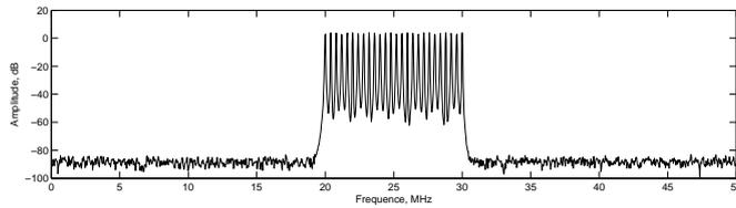
être considéré comme étant issu du standard GSM, qui garantit qu'à chaque instant les canaux effectuant des sauts de fréquence, avec des séquences pseudo-aléatoires, sont espacés de 400 kHz, l'ensemble de porteuses peut être modulé en GMSK (Gaussian Minimum Shift Keying), mais dans cet exemple, on ne considère que des porteuses non modulées.
