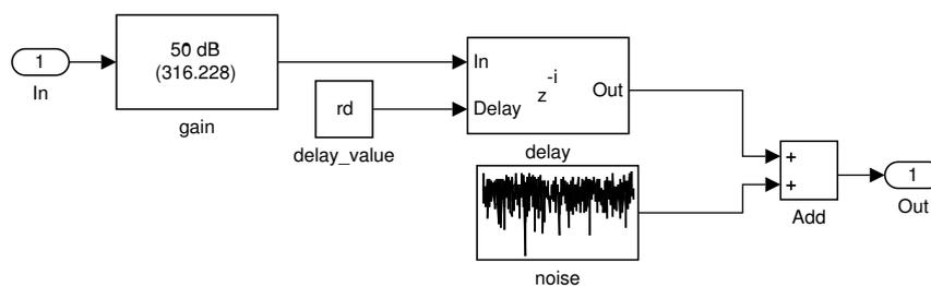
FIGURE 2.16 – Modèle simplifié d'un répéteur de radiocommunication.
