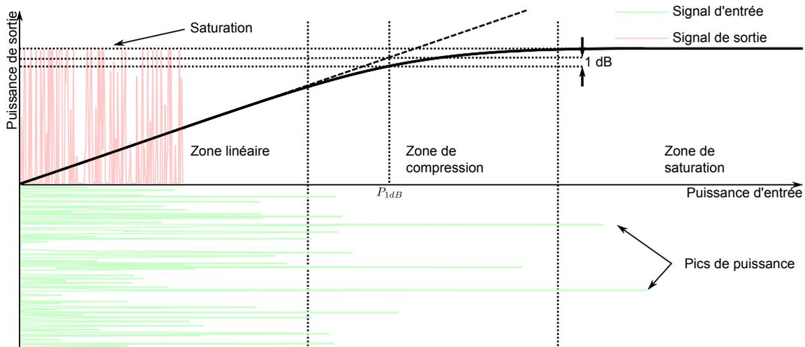
FIGURE 7.9 – Caractéristiques d'un amplificateur de puissance.
