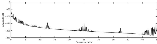
contre. Un filtre d'ordre 8 à la fréquence d'échantillonnage  $f_s = 100$  MHz, suffit pour les atténuer d'au moins 50 dB.
