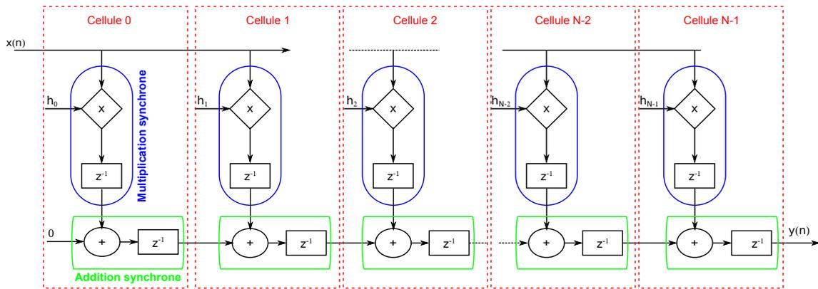
FIGURE C.16 – Structure directe du FIR optimisée pour VHDL.
