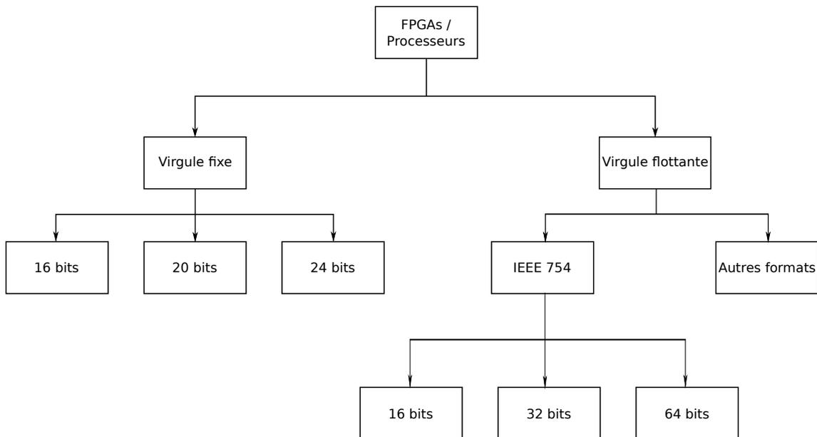
FIGURE C.1 – Les représentations les plus courantes des nombres dans les processeurs et les FPGAs.
