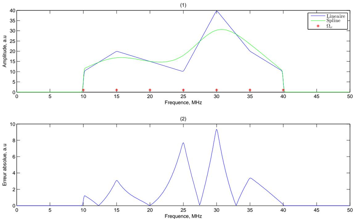
FIGURE 5.4 – Filtre correcteur d'ordre 1000, comparaison entre interpolation linéaire et interpolation par Spline.
