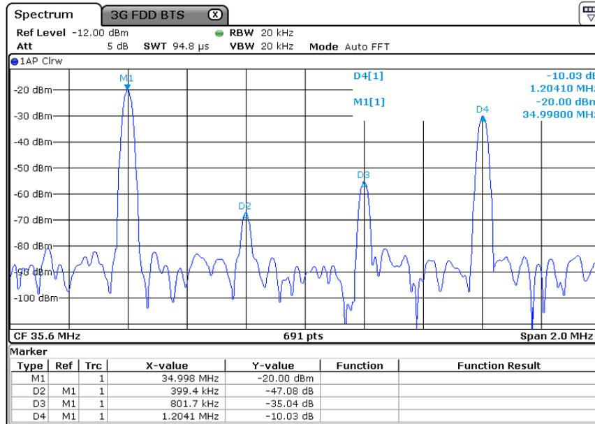
FIGURE 4.23 – Exemple d'un signal délivré par **RandomHopping8cx**.
