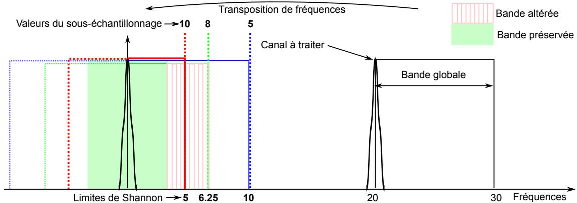
FIGURE 4.14 – Sous-échantillonnage avec autorisation du repliement spectral.
