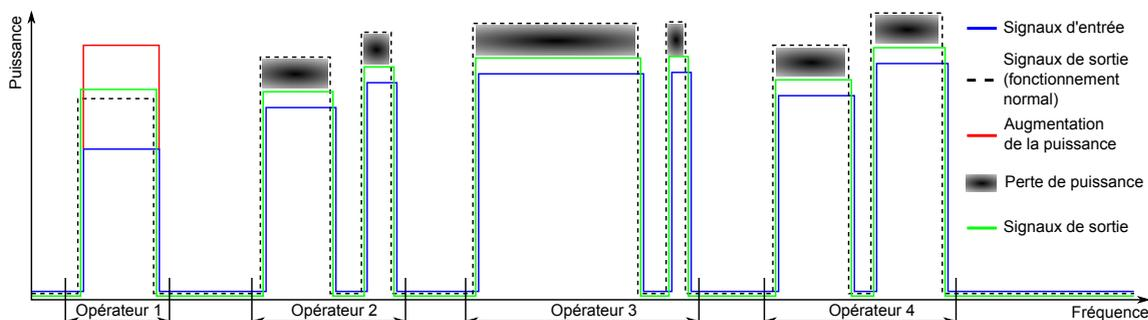
FIGURE 7.1 – Limitation de la puissance due à l'augmentation de la puissance d'un opérateur.
