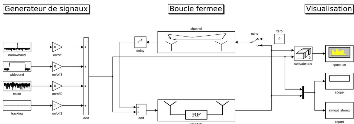
FIGURE 2.15 – Simulateur de l'écho - système en boucle-fermée.
