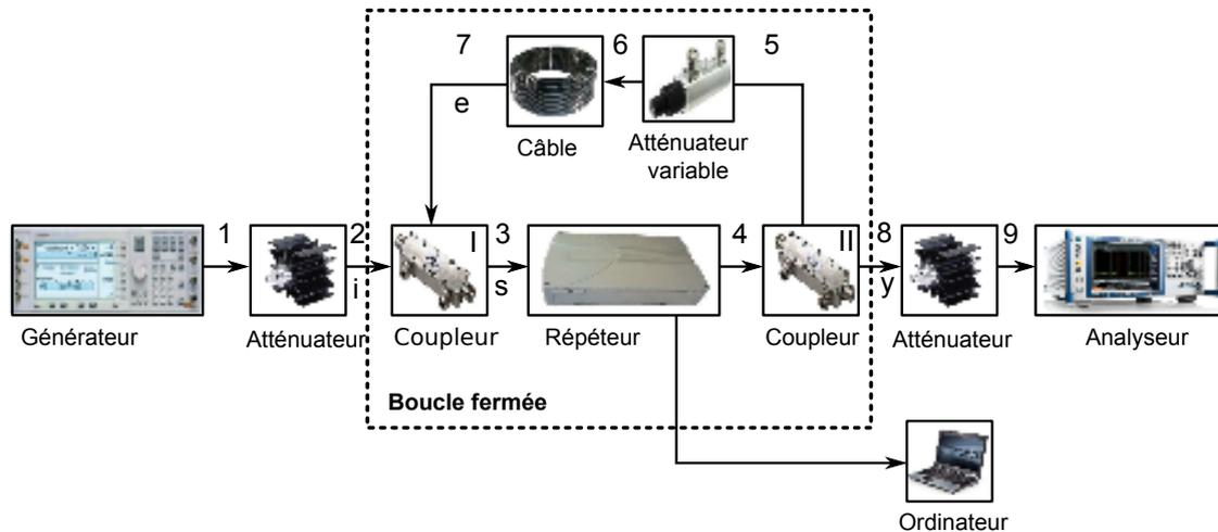
FIGURE 2.25 – Synoptique d'un système en boucle-fermée. Reproduction l'écho en laboratoire.
