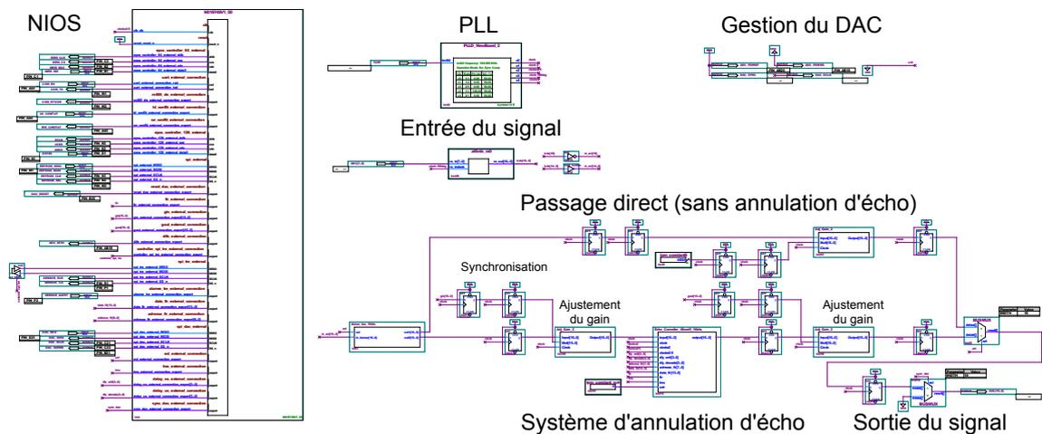
FIGURE C.21 – Schématique (top view) du système d'annulation d'écho.
