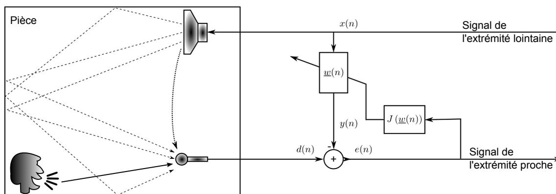
FIGURE 3.6 – Diagramme d'annulation d'écho dans les systèmes téléphoniques.
