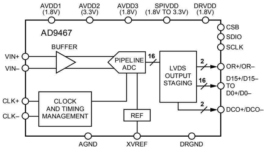
FIGURE 6.7 – Synoptique fonctionnel de l'ADC AD9467.
