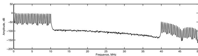
8 suffit pour atténuer cette bande de 50 dB comme le montre la figure ci-contre. En pratique, cette bande supradyne atténuée sera noyée dans le bruit ambiant du système électronique.
