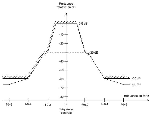
FIGURE 1.2 – Gabarit d'un canal GSM.
