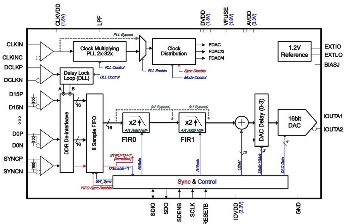
FIGURE 6.8 – Synoptique fonctionnel du DAC DAC5681Z.
