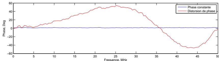
FIGURE 5.11 – Distorsion en phase d'un signal large bande.
