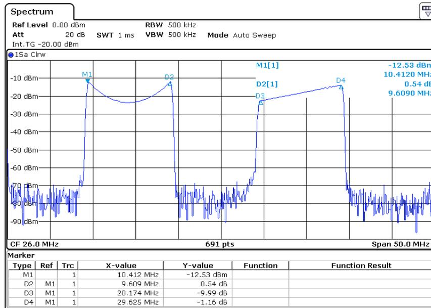
FIGURE 5.10 – Allure du signal de sortie d'un filtrage multi-bande associé à la pré-distorsion en amplitude, excité en entrée par un signal de type tracking.
