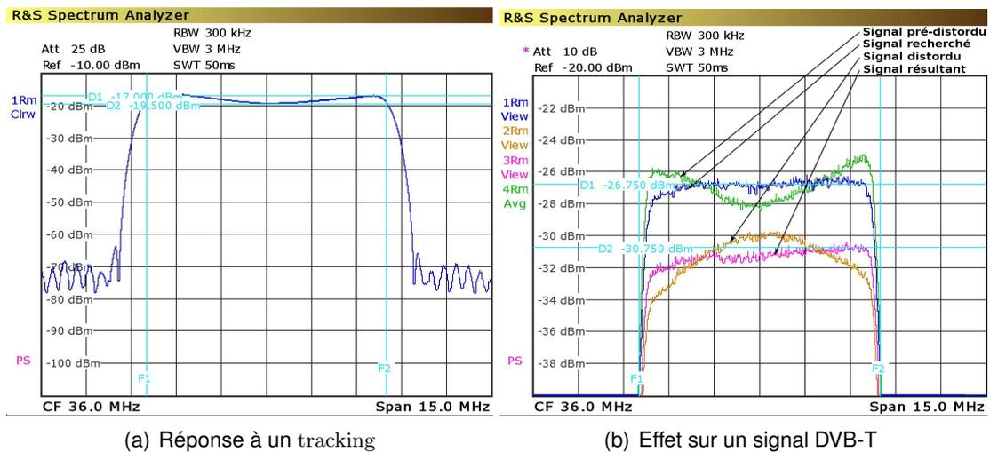
FIGURE 5.5 – Application sur un signal DVB-T (Digital Video Broadcasting-Terrestrial).
