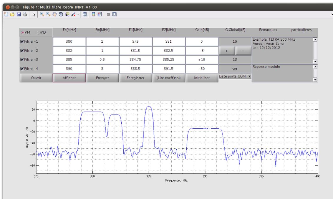
FIGURE B.7 – Interface de configuration du SmartFilter.
