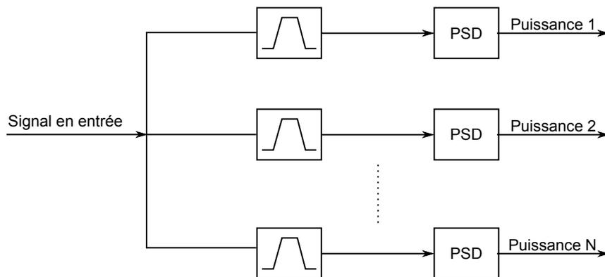
FIGURE 7.2 – Synoptique de détection de puissance dans le domaine temporel.
