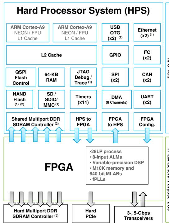
FIGURE 6.10 – Architecture du microprocesseur intégré ARM®Cortex™-A9.
