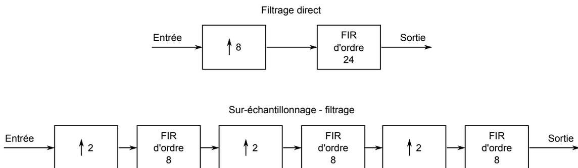
FIGURE 4.17 – Synoptique de la technique du sur-échantillonnage, comparaison de la solution de filtrage direct et de la solution sur-échantillonnage/filtrage
