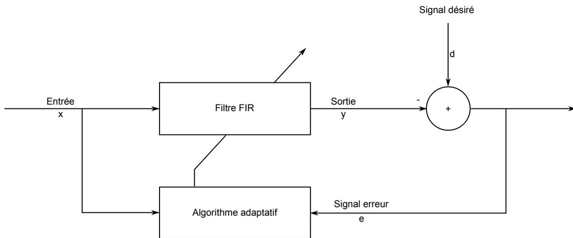
FIGURE 3.2 – Filtre adaptatif utilisant l'erreur pour la mise-à-jour de ses coefficients.
