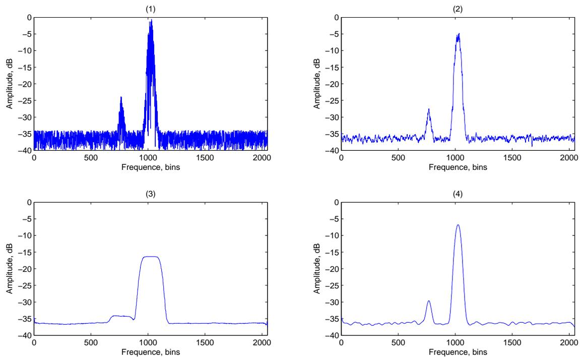
FIGURE 4.10 – Lissage du signal provenant de la FFT.
