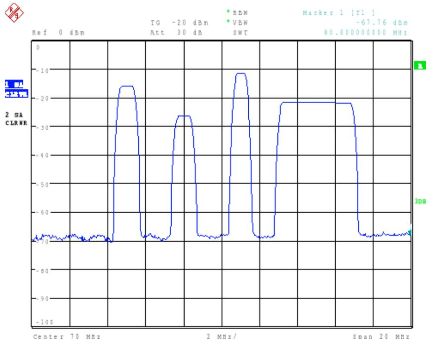
FIGURE 5.8 – Exemple de résultat expérimental d'un filtre multi-bande, aux gains variables.
