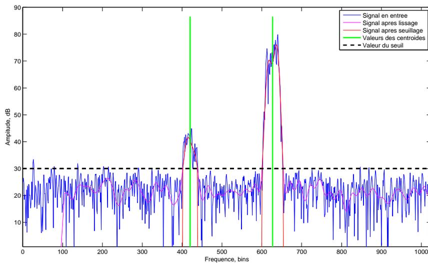
FIGURE 4.11 – Illustration des étapes de l'algorithme *Peak detector*.
