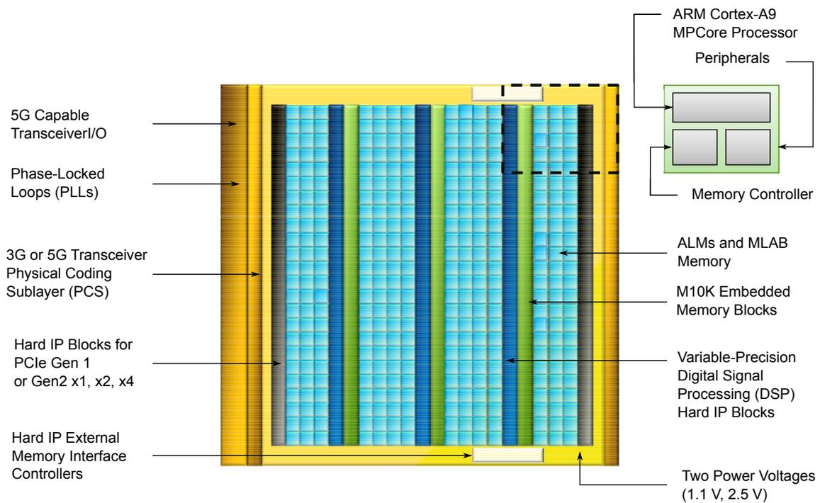
FIGURE 6.9 – Vue d'ensemble du Cyclone V.
