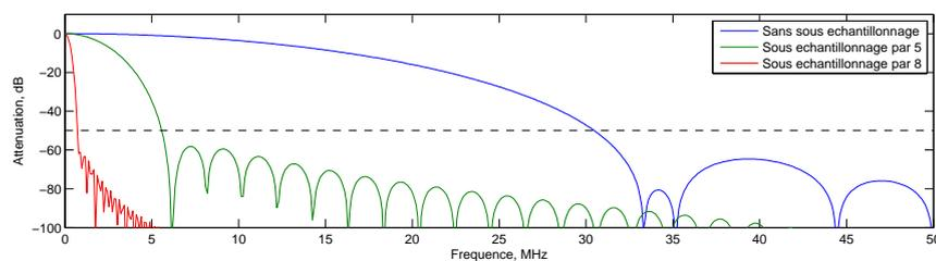
FIGURE 4.15 – Effet du sous-échantillonnage sur la sélectivité des filtres FIRs.
