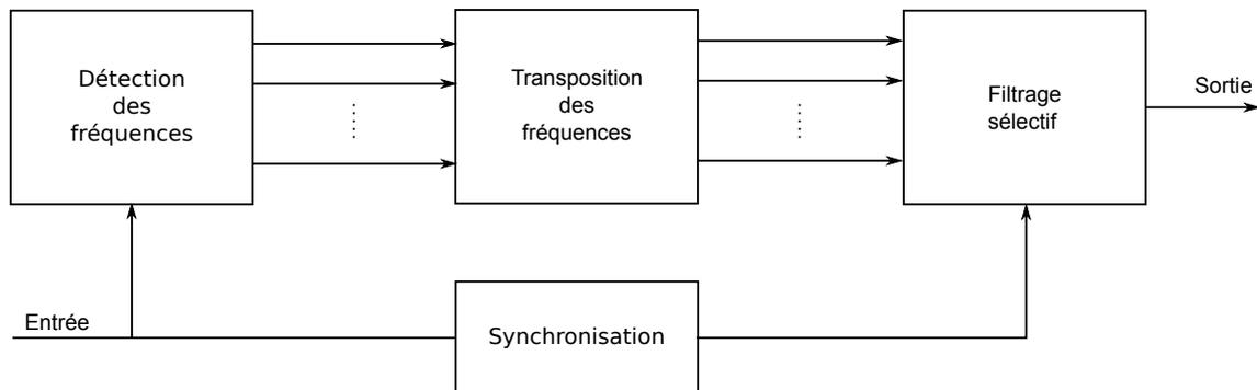
FIGURE 4.19 – Synoptique du filtrage automatique pour N canaux.
