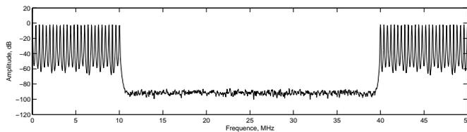
dyne (utile) se trouve dans l'intervalle  $[0, 10]$  MHz, et la bande supradyne dans l'intervalle  $[40, 50]$  MHz. Le canal à filtrer est en bande de base.
