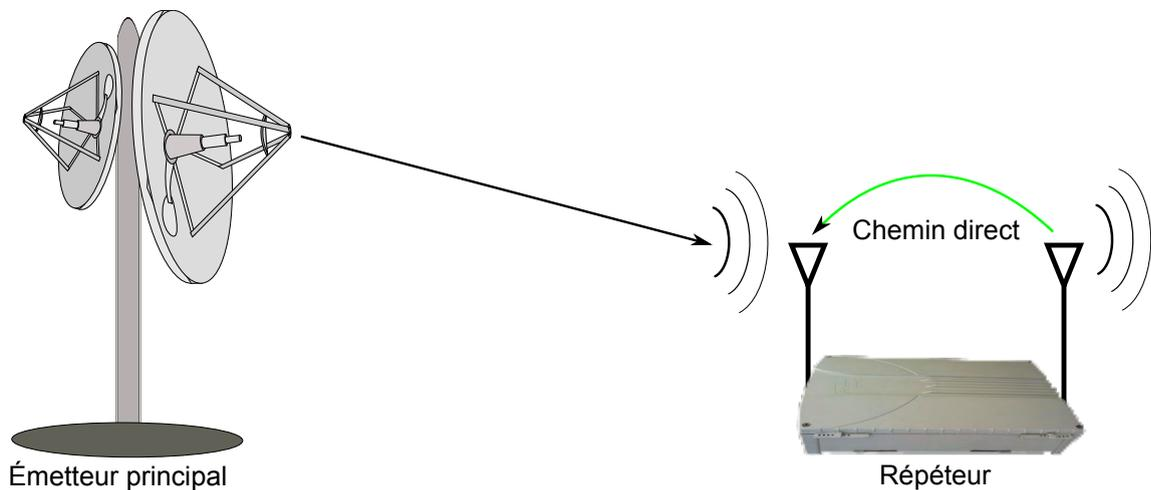
FIGURE 2.2 – Configuration simplifiée (chemin direct) de l'écho.
