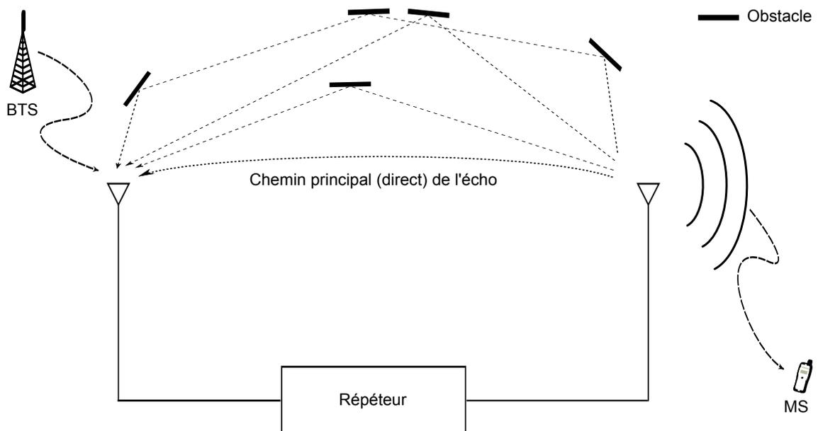
FIGURE 1.11 – L'écho radio-fréquence produit par les chemins multiples.
