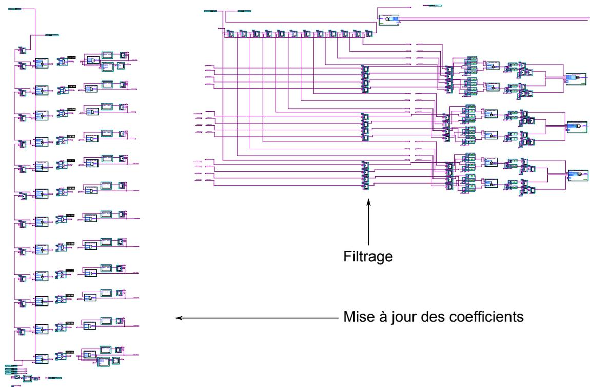
FIGURE C.22 – Schématique d'un bloc élémentaire d'annulation d'écho (12 coefficients).
