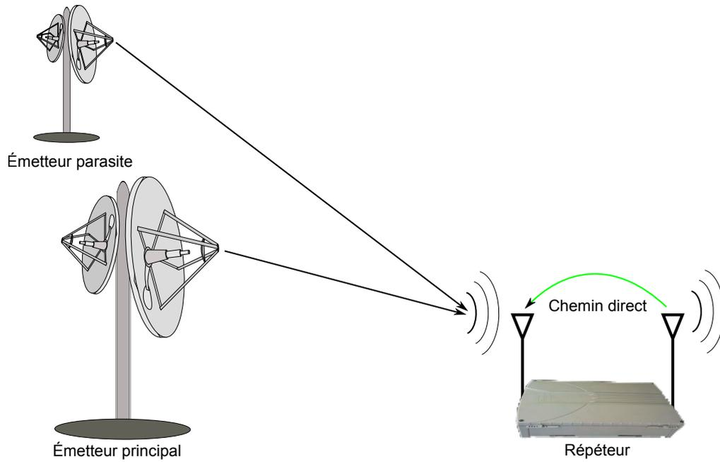
FIGURE 2.7 – Configuration du cas d'un émetteur parasite.
