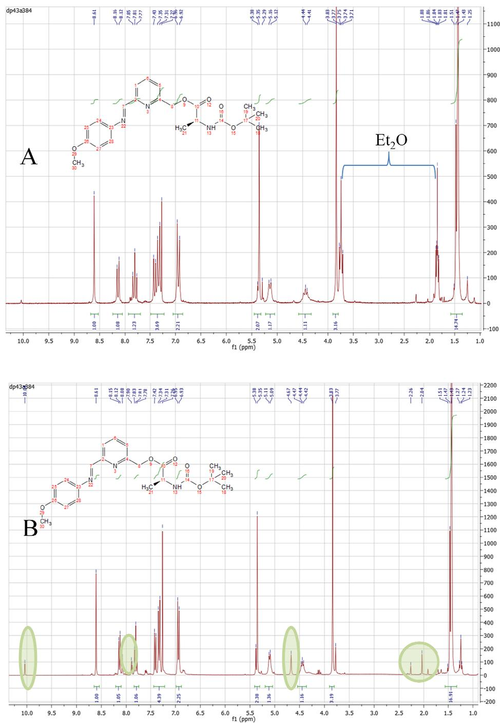
**Figure 14:** Spectre RMN du proton du composé **A53**, à  $t = 0$  (A) et à  $t = 1h$  (B).
