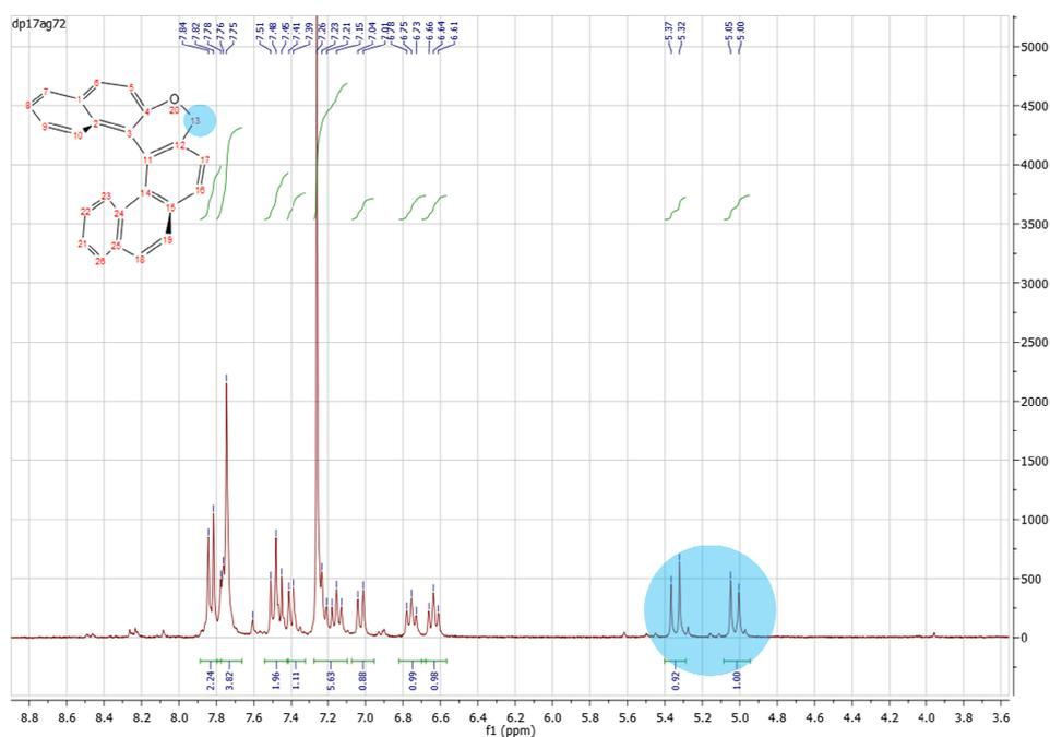
**Figure 33:** Spectre RMN <sup>1</sup>H du composé **B15**.
