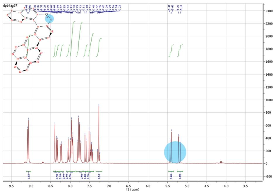
**Figure 32:** Spectre RMN  $^1\text{H}$  relatif au composé **B9**.
