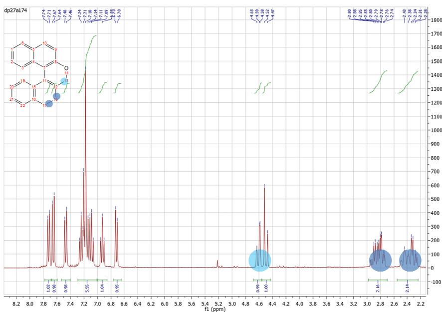
**Figure 31:** Spectre RMN  $^1\text{H}$  du composé **B5**.
