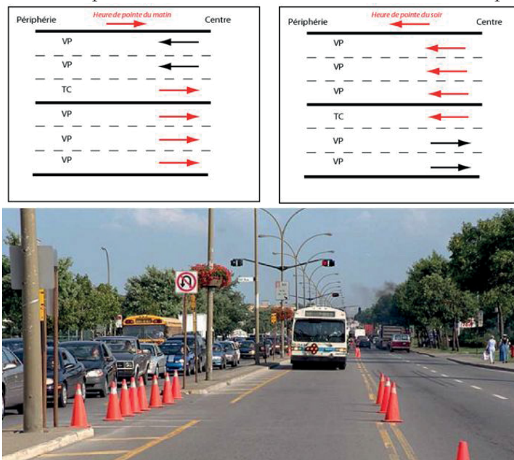
FIGURE D.6 – Principe des voies réservées à contre-sens et exemple à Montréal
