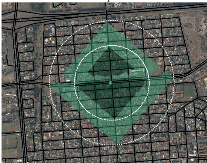
FIGURE 5.3 – Accessibilité théorique et réelle dans un tissu de type damier
