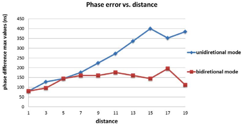
Figure 9: La valeur maximale de l'erreur de phase en fonction de la distance par rapport à l'horloge de référence
