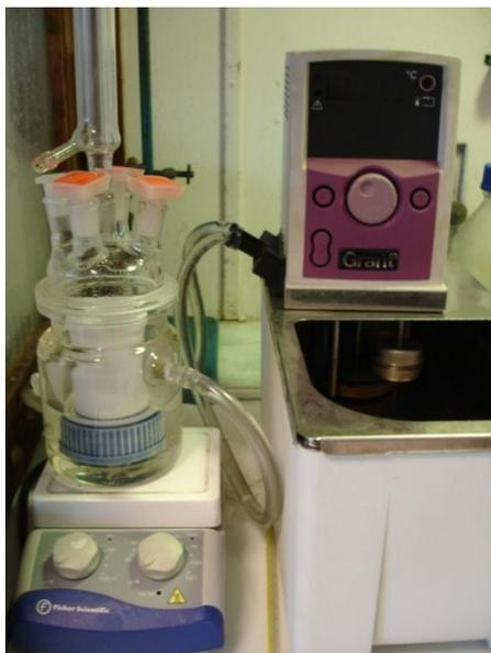
Figure 0-6 : Système de chauffage pour l'agitation magnétique
