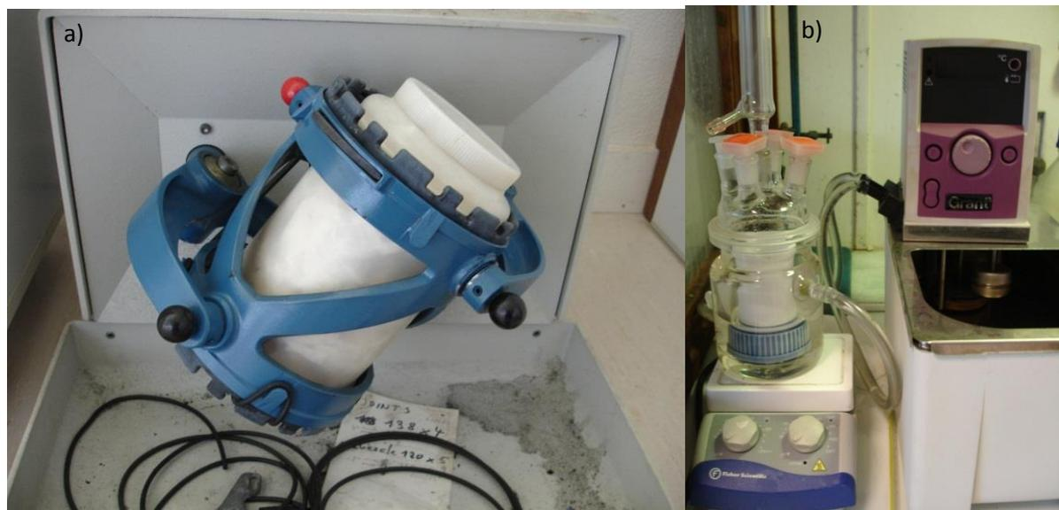
**Figure I-8 : a) Photo du turbula b) Photo du montage utilisé pour l'agitation magnétique**
