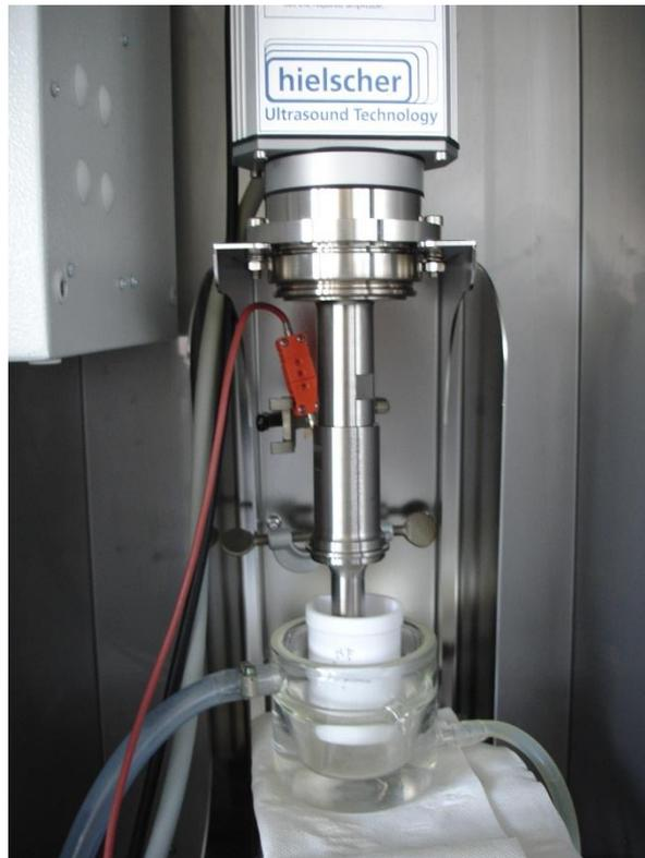
Figure 0-3 : Sonolyse directe avec le réacteur Hielscher
