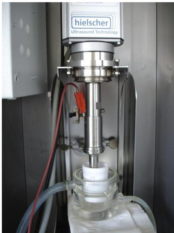
**Figure I-16 : Sonolyse directe avec le sonoréacteur Hielscher**
