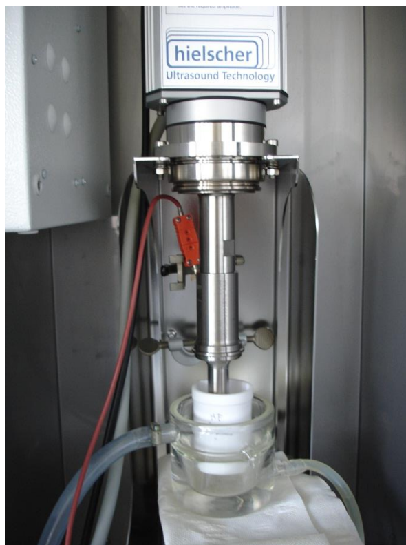
Figure 0-3 : Sonolyse directe avec le réacteur Hielscher
