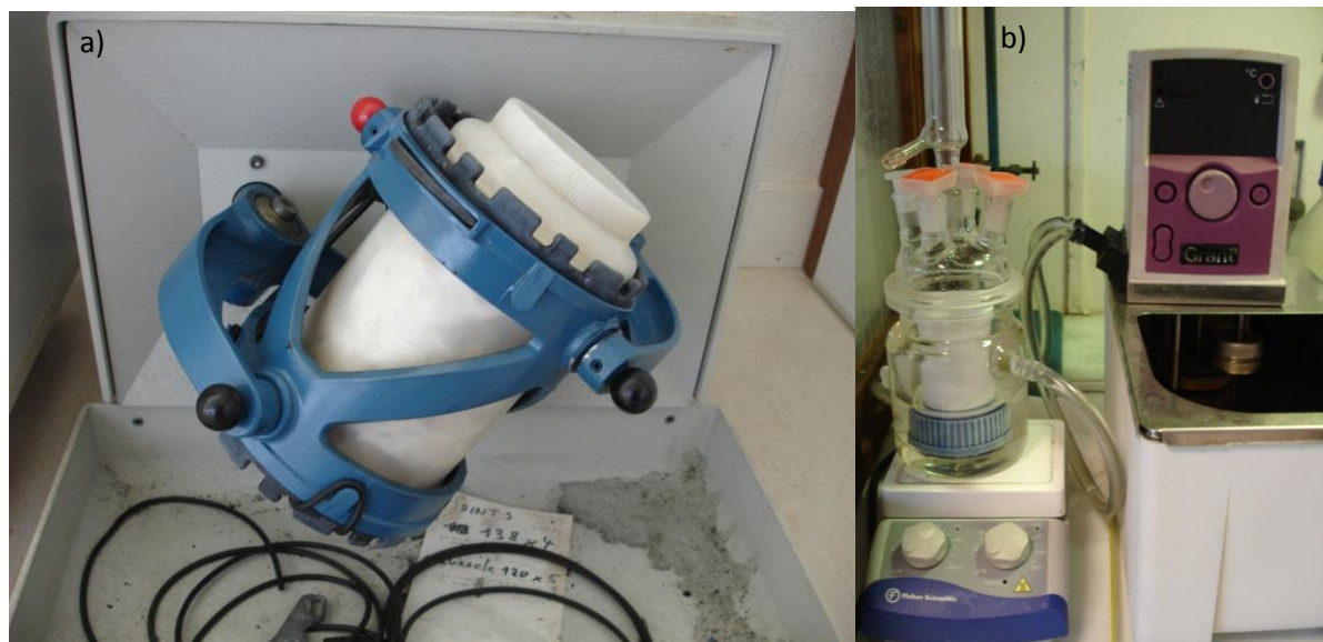
Figure I-8 : a) Photo du turbula b) Photo du montage utilisé pour l'agitation magnétique
