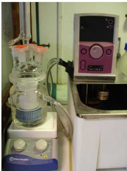
Figure 0-6 : Système de chauffage pour l'agitation magnétique
