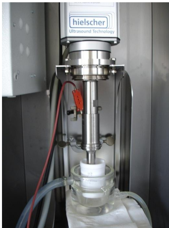
Figure I-16 : Sonolyse directe avec le sonoréacteur Hielscher
