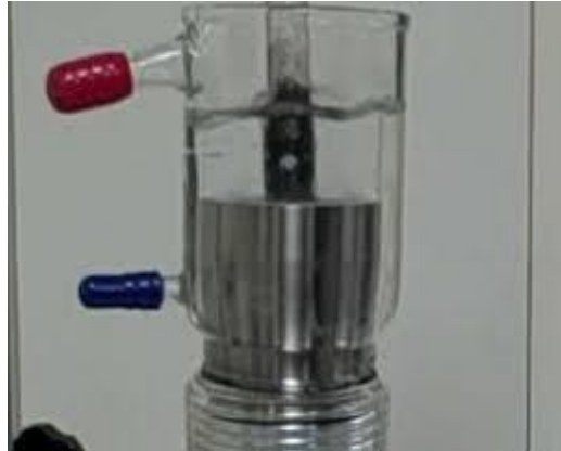
Figure I-15 : Exemple de système « cup-horn », avec utilisation d'un tube à essai en verre contenant le milieu étudié
