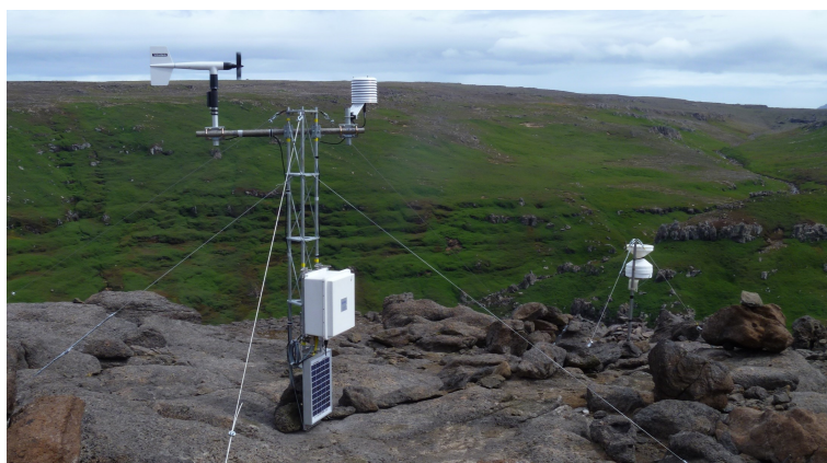
FIGURE 2.7 – Station météorologique CR200 et pluviomètre du réseau LEFE-KCRUMBLE installés sur le site de Sourcils Noirs (Photo : Nina Marchand).
