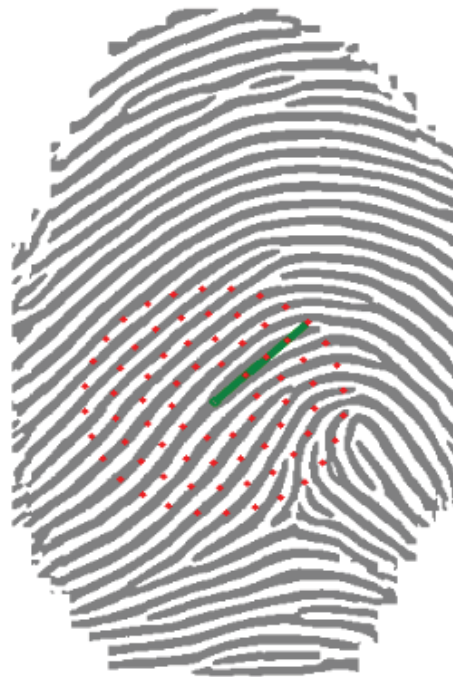
FIGURE 3.38 – Points de quantification du descripteur de Tico autour de la minutie de référence
