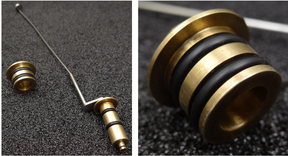
Figure 6.30 : Vanne à bille de Symbol. [A gauche] l'ensemble du dispositif avec en haut de l'image la vanne en elle-même, reliée à la tige, qui, par rotation l'ouvre et la ferme. [A droite] le système reliant la tige à la roue que tourne l'opérateur à l'extérieur du cryostat. C'est l'un de ces deux joints qui entraîna la fuite.
