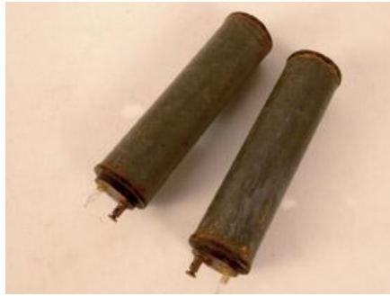
Figure 1.5 : Le compteur Geiger-Müller développé en 1928.
