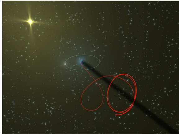
Figure 2.9 : La trajectoire de Planck jusqu'à L2, puis l'orbite de Lissajous pour éviter l'ombre de la Terre. Source : ESA / Planck HFI-LFI consortium
