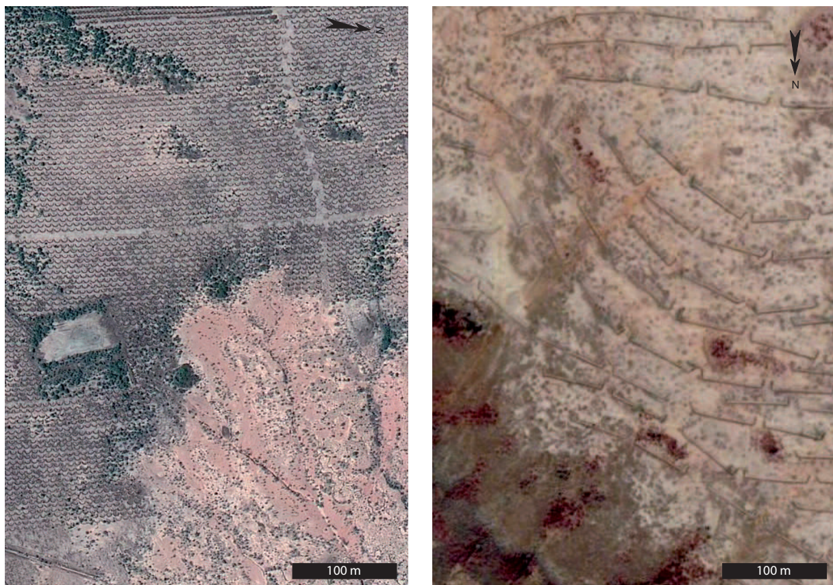
Figure I.22. Photographie aérienne de dispositifs de lutte contre l'érosion : les demi-lunes (13°34'30''N-2°27'20''E) (g.) et les agrafes (13°28'22''N-2°03'25''E) (d.) (Images Google Earth)
