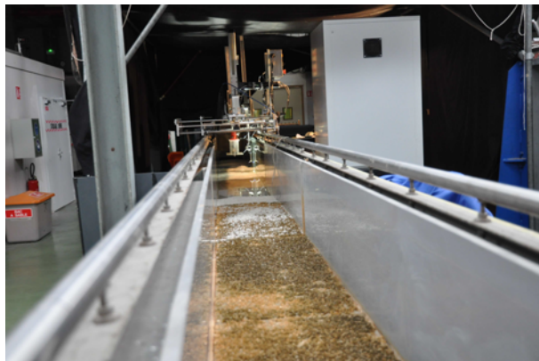
FIGURE 3.1 – Photographie du canal à surface libre.
