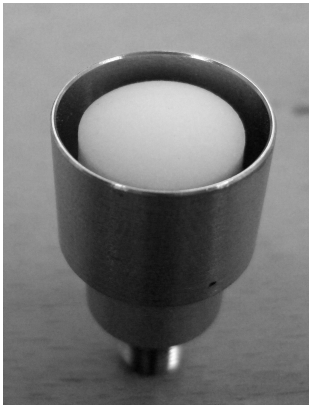
FIGURE 5.2 – (gauche) Collecteur cosinus fait maison utilisé pour mesurer l'albédo spectral avec AutoSolExS. (droite) Fonction S_{\lambda}(\theta) à \lambda = 900 nm pour l'un des collecteurs utilisés et pour un collecteur cosinus commercial.
