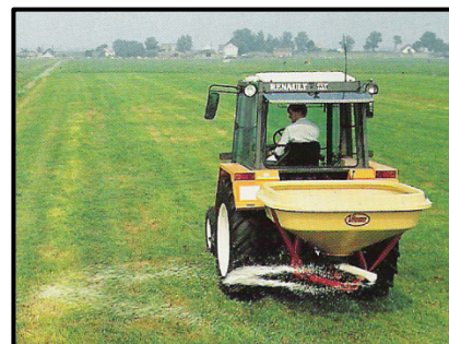
Figure 5 : Le bras pendulaire, une technique pour reproduire le geste auguste du semeur.
