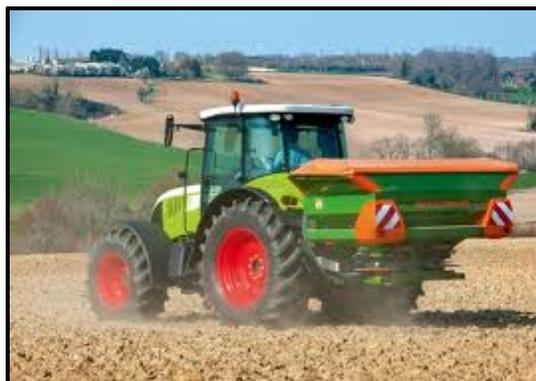
Figure 6 : Distributeur d'engrais centrifuge.
