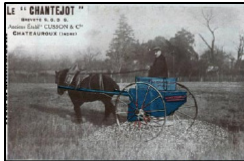
Figure 4 : Distributeur d'engrais et semoir à la volée pour grains, « à grand rendement ». (Chateauroux 36000)
