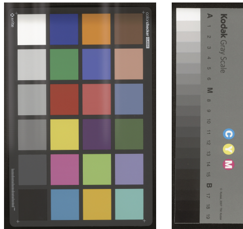
FIGURE 4.21: Deux exemples de mires. La mire de gauche est la Colorchecker Classic de X-rite et la mire de droite est la Q13 de Kodak.
