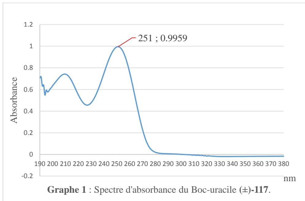
Or, un filtre en pyrex ne laisse passer que les irradiations supérieures à 290 nm, alors qu'un filtre en quartz laisse passer les irradiations supérieures à 200 nm, ce qui pourrait exciter des liaisons non désirables et former des produits secondaires. Pour résoudre cela, un photosensibilisateur a été utilisé. Un photosensibilisateur subit l'excitation photochimique ( $\text{sens}^*$ ) et transfère son excès d'énergie à une autre molécule (**117**) dans le même environnement :
