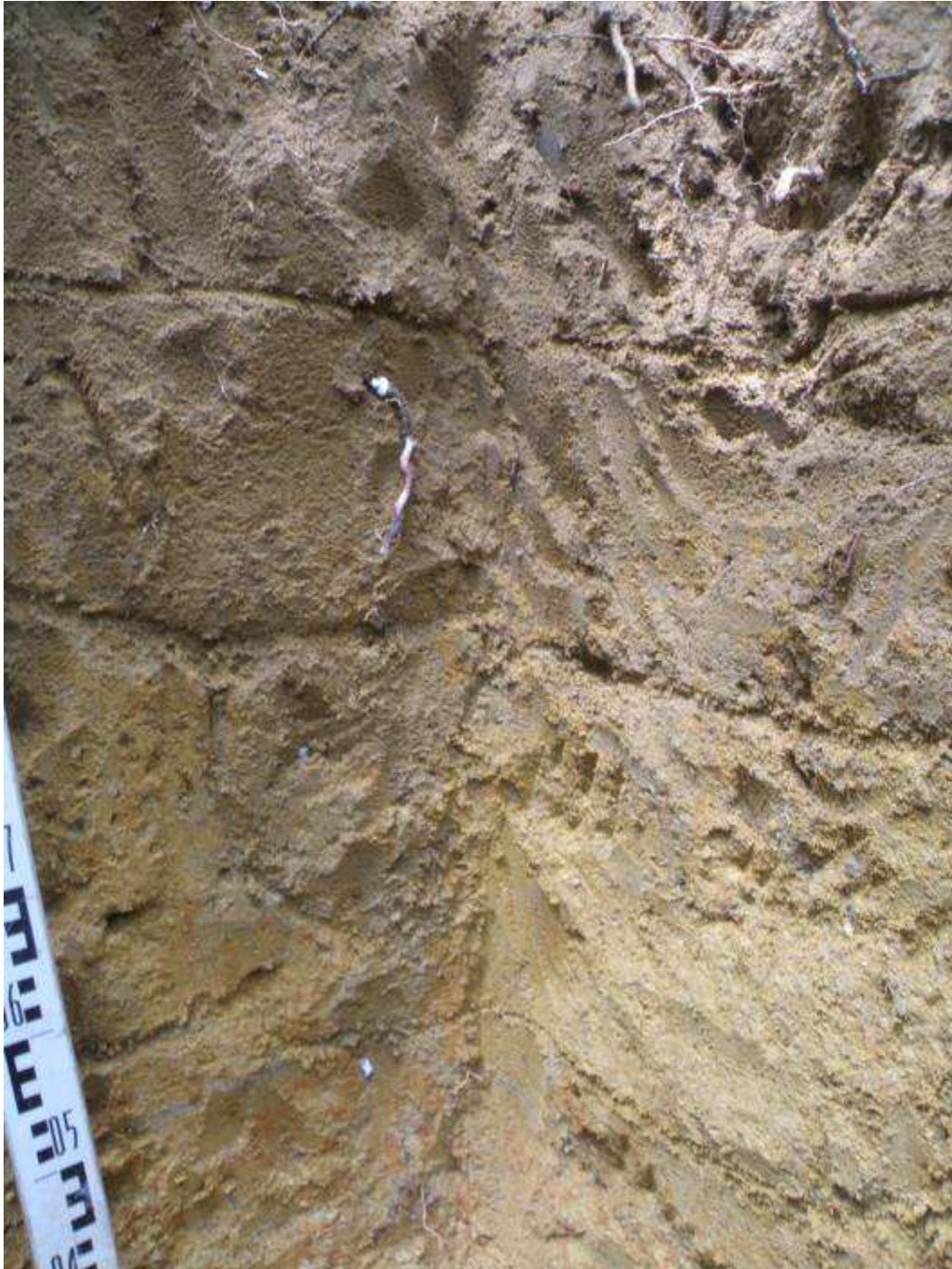
Photo 4-5 : l'horizon 2 brun avec tâche pénètre l'horizon 3 (orange avec tâche) en suivant une racine de baaka mapa verticale bien visible en haut de profil et qui réapparaît en profondeur avec son latex blanc
