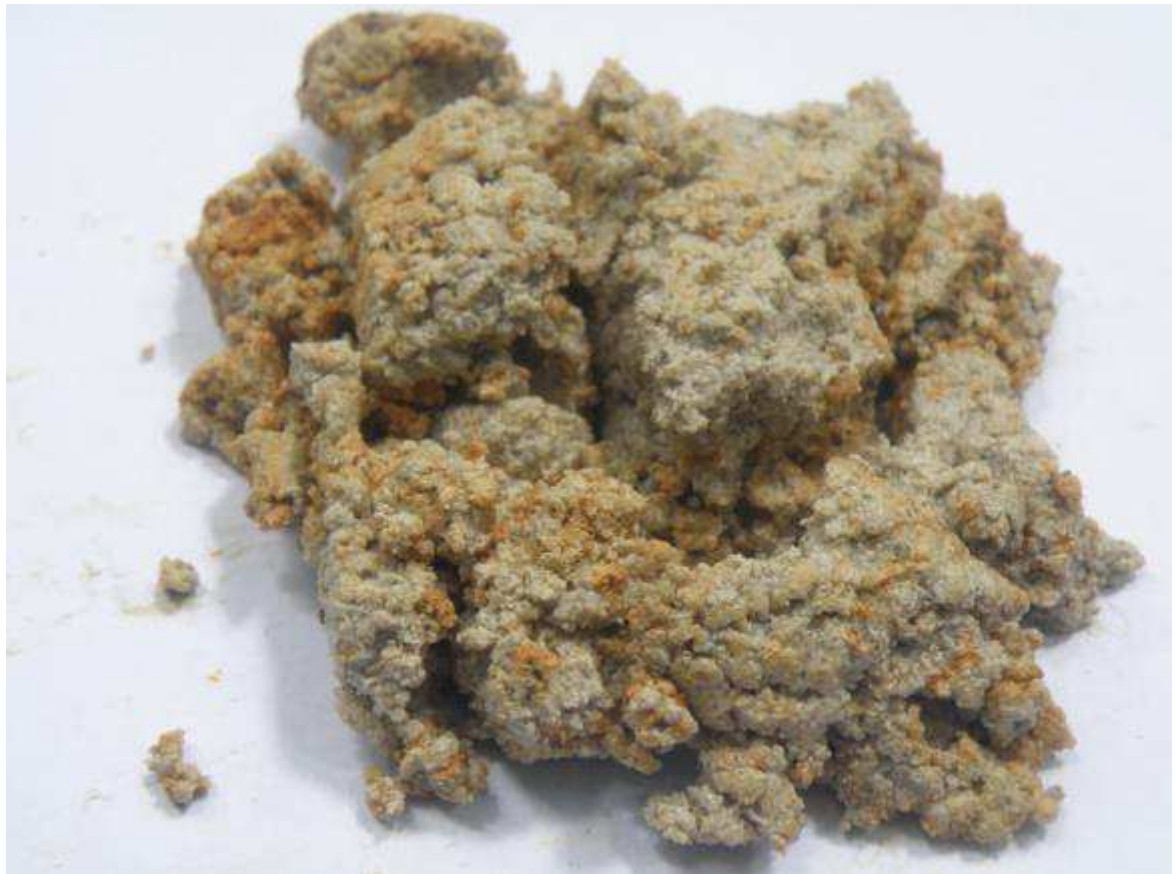
Photo 3-6 : horizon 3 avec nombreuses tâches de décoloration - autres photos 427 à 436
