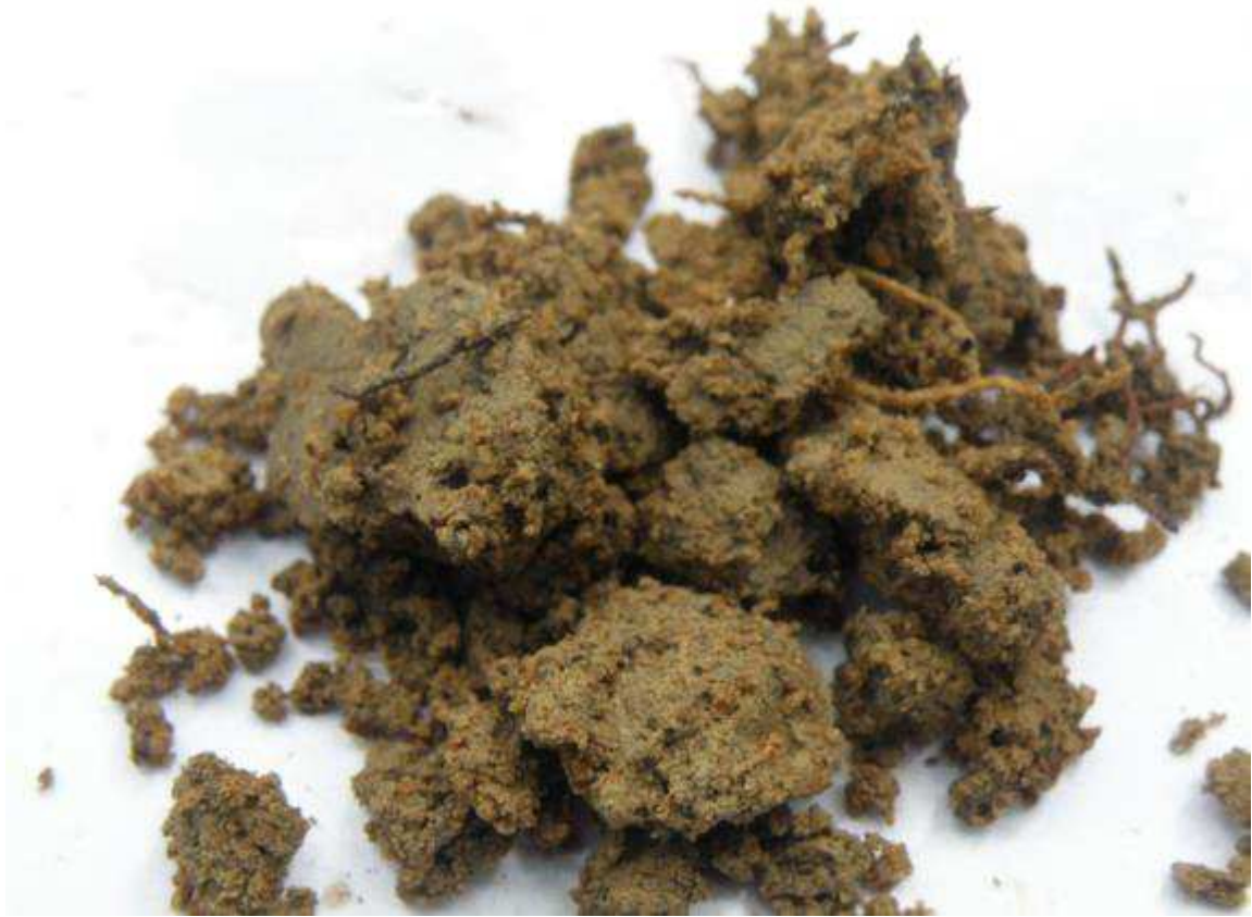
Photo 2-4 : horizon 1 avec tâches peu nombreuses et peu nettes – structure polyédrique – autres photos 215 à 223 et 255 à 263
