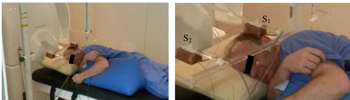
Figure 5.2.1 : Configuration choisie lors des enregistrements de réponses évoquées auditives menés avec les OPMs. Parallèlement aux sessions, des enregistrements ECG ont été réalisés. S_1 et S_2 désignent respectivement les sondes 1 et 2.
