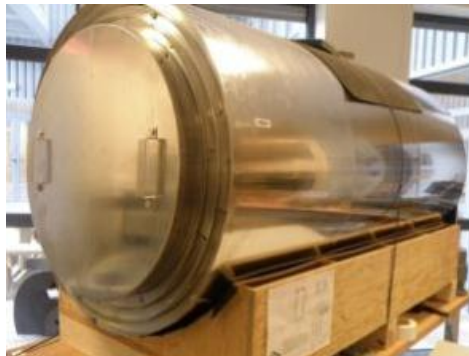
Figure 2.2.2 : Représentation de la chaîne de mesure mise en place. L'observable est ici la pente de résonance obtenue en sortie de la boucle ouverte, i.e. directement en sortie de la détection synchrone. Pour observer cette pente, une rampe de champ externe de +/- 500 nT à 5 Hz de part et d'autre du champ nul est générée suivant l'axe de la mesure. A gauche, photographie de la sonde placée au centre de bobines d'Helmholtz générant les rampes de champ. A droite, exemple de pente de résonance obtenue.
