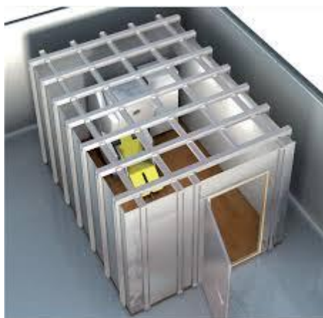
Figure 2.4.2 : Représentation de la chambre blindée de Clinatéc.
