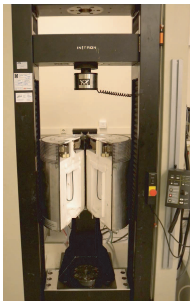
FIGURE 3.34 – Dispositif d'essai à hautes températures.
