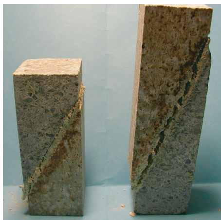
(a) Rupture à l'interface (b) Rupture dans le mortier FIGURE 3.30 – Localisations de la zone de rupture.
