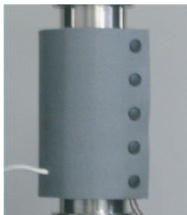
FIGURE 2.10 – Collier chauffant autour du cylindre en acier.
