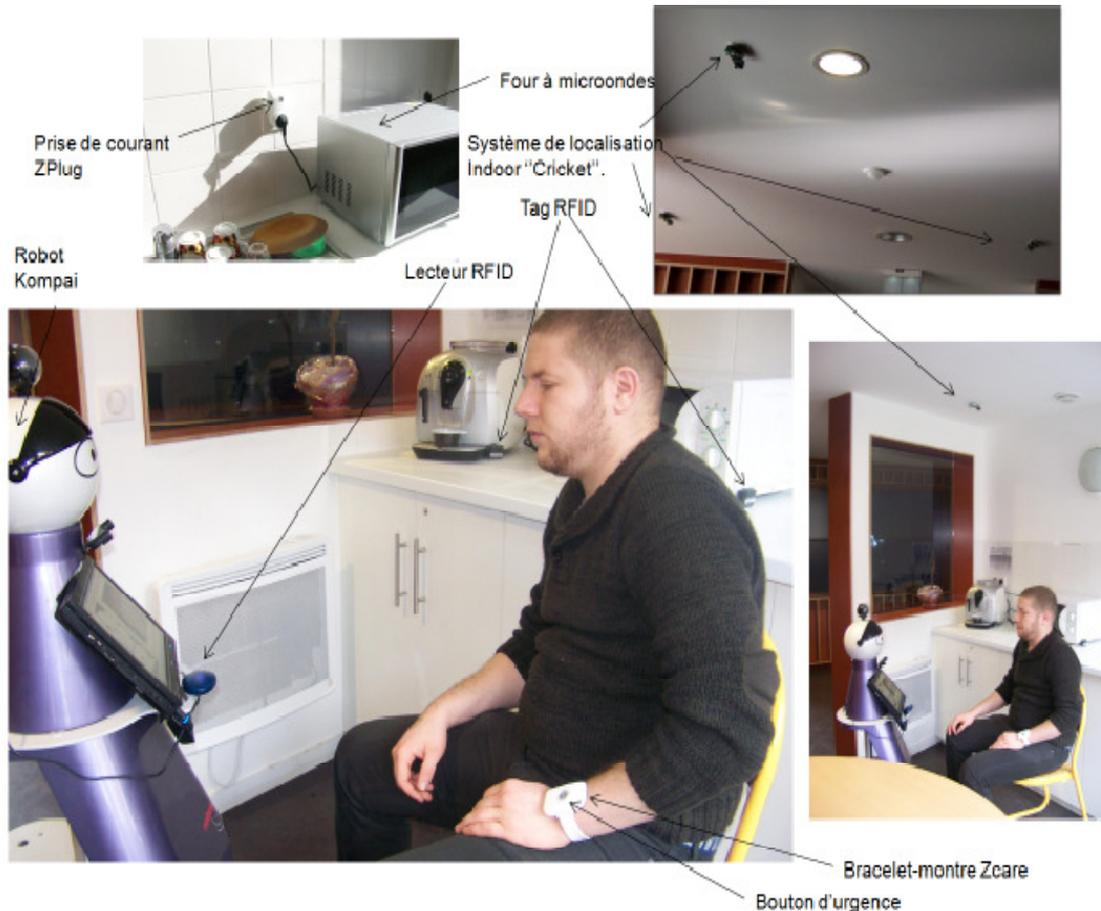
Figure 7.1 : Vue partielle de la plateforme ubiquitaire du Laboratoire LISSI.
