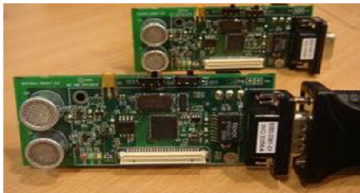
Figure 7.5 : Le système de localisation indoor "Cricket".
