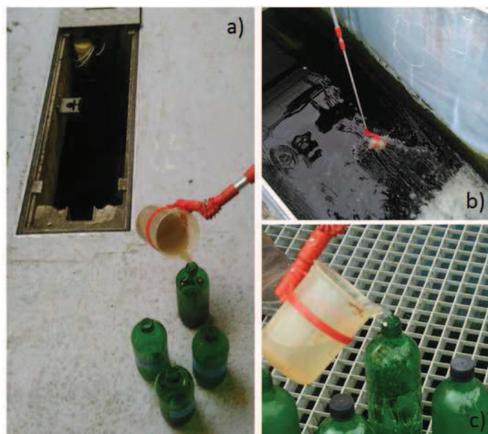
Figure 30: Photographies des prélèvements réalisés sur site à la STEP de Rennes, prélèvements des eaux d'entrée (a) et des eaux de sortie (b, c)
