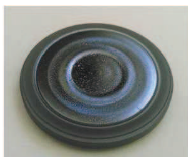
Figure 10 : Photographie d'une cible de verre de chalcogénure 2S1G-Se-2 après plusieurs heures de dépôt
