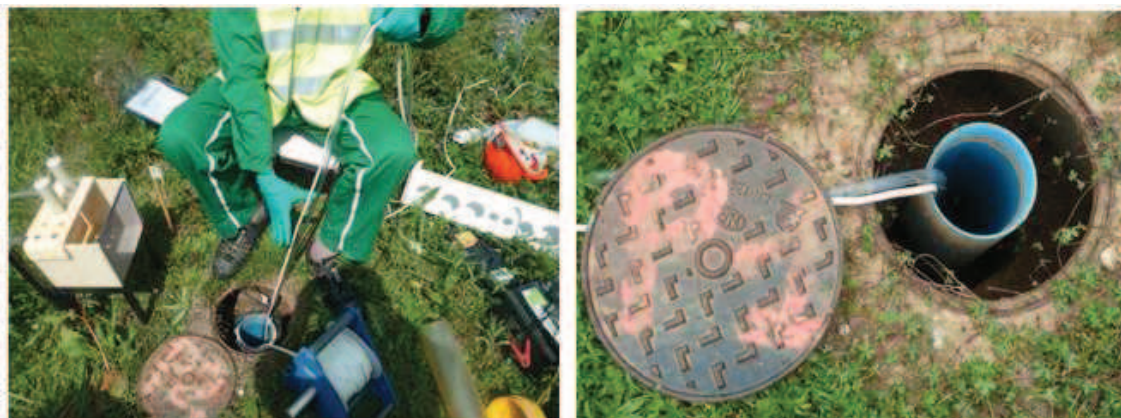
Figure 26 : Photographies des prélèvements réalisés sur site dans les piézomètres sur l'Aire des Lisses
