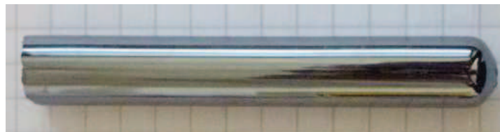
Figure 10 : Barreau de verre (\text{GeSe}_2)_{80}(\text{Sb}_2\text{Se}_3)_{20} (2S1G-Se-3) (diamètre 12 mm et longueur \approx 6.5 cm)
