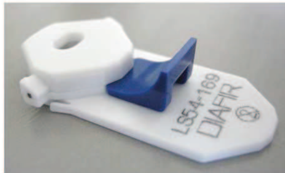
Figure 15 : Biocapteur IR DIAFIR fonctionnant selon le principe de la spectroscopie FEWS
