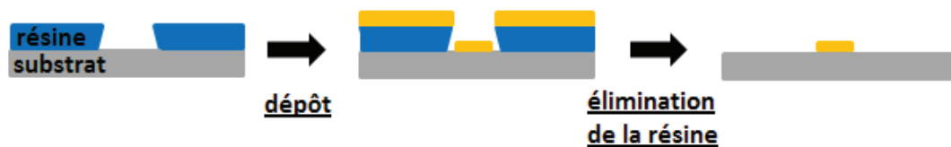
Figure 13 : Schéma de principe du lift-off
