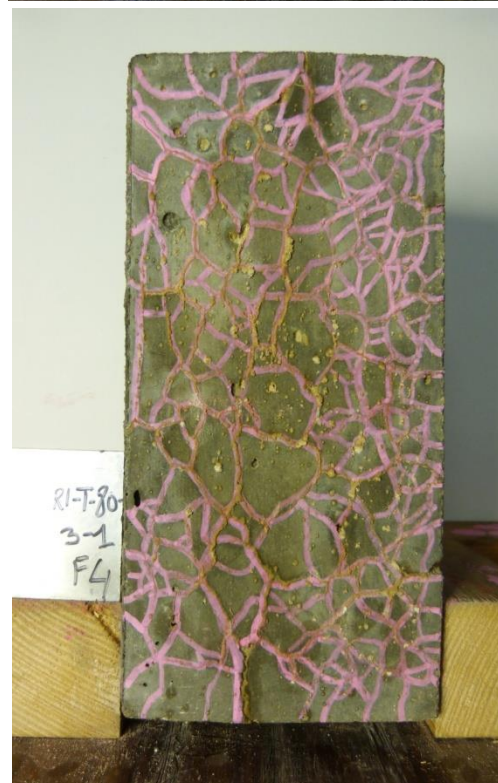
Figure 118 : Comparaison des relevés de fissures en fin d'expansion du béton R1 traité à 81°C pendant 3 jours (a) : au jeune âge ; (b) : après 100 jours
