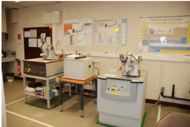
Image 1 : Vue d'ensemble les installations de diffraction des rayons X.
