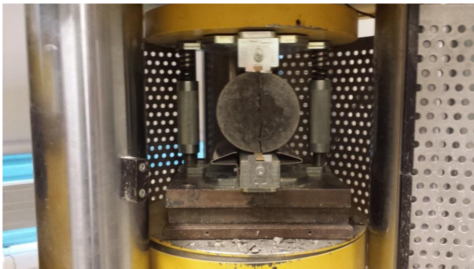
Figure 61 : Essai de traction par fendage (presse du laboratoire Navier)
