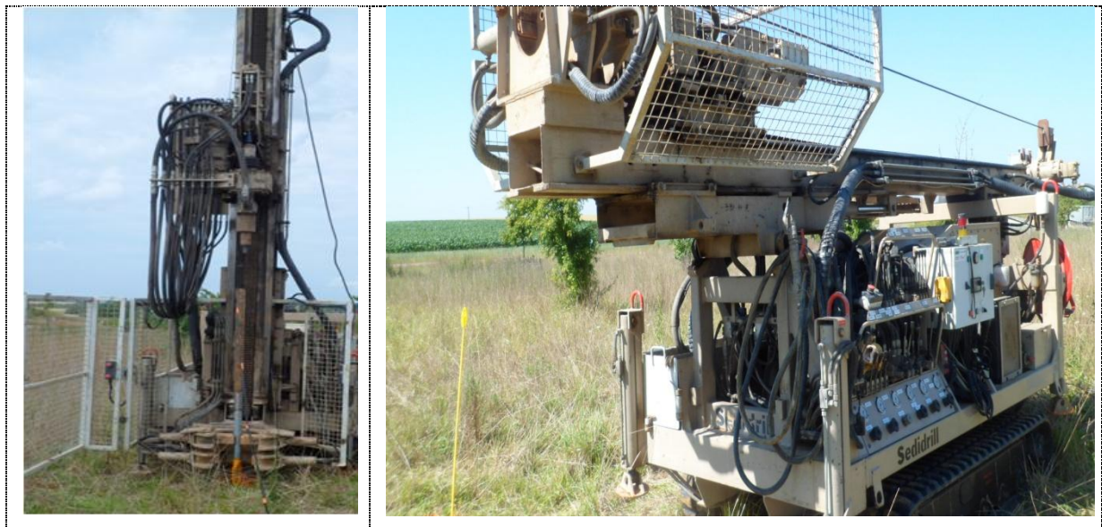
Figure 4. 16. Fonçage du capteur de pression
