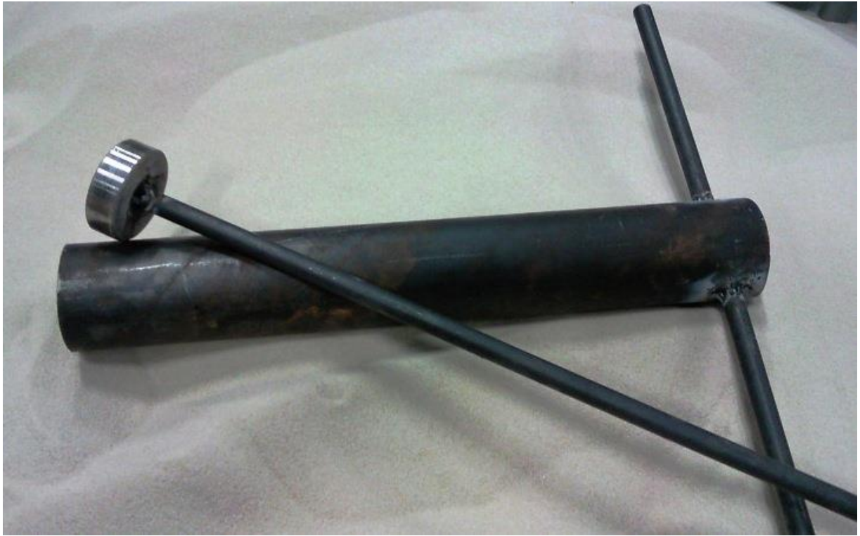
Figure 156 : outil utilisé pour la mise en place des colonnes de soil mixing
