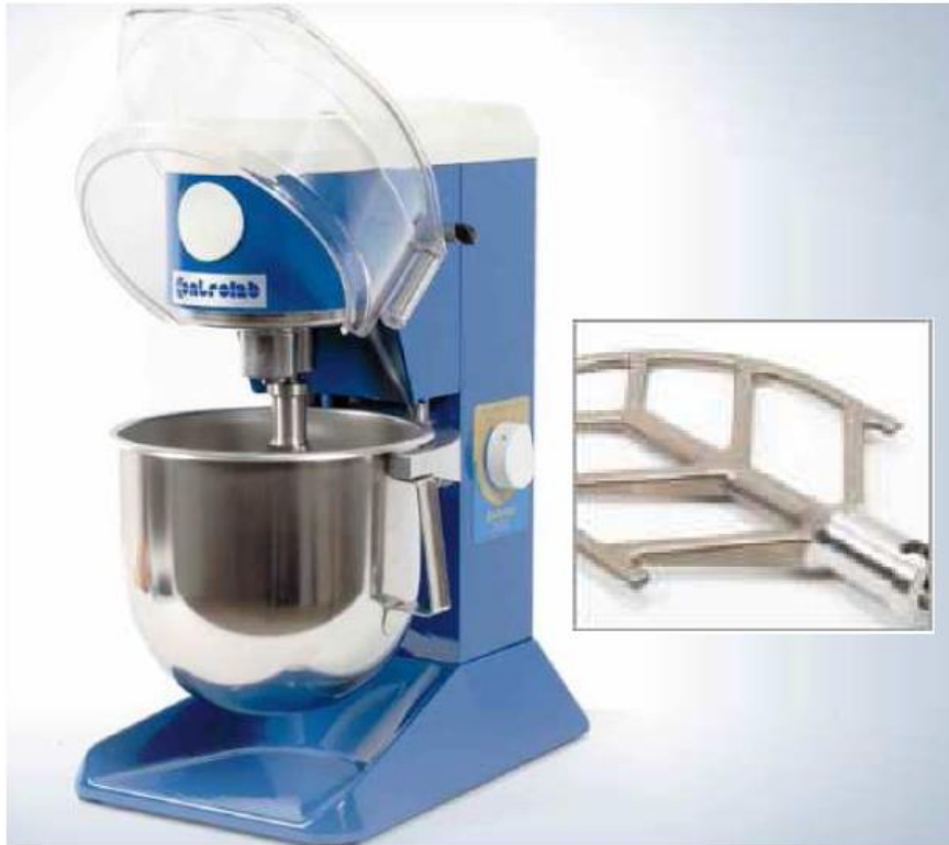
Figure 25 : malaxeur utilisé pour la préparation du matériau de soil mixing
