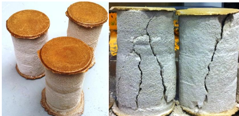
Figure 53 : Eprouvettes surfacées provenant des colonnes de soil mixing (à gauche) – Eprouvettes après un essai de compression simple (à droite)
