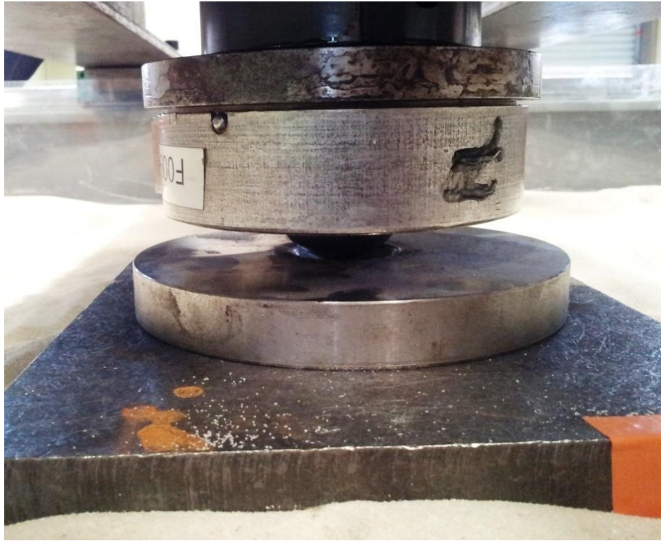
Figure 152 : système mis en place lors des essais de chargement permettant la rotation de la semelle – capteur de force sous le vérin
