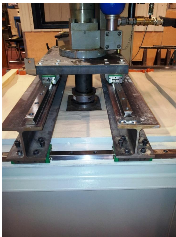
Figure 151 : système de guidage sur railles permettant le positionnement du vérin
