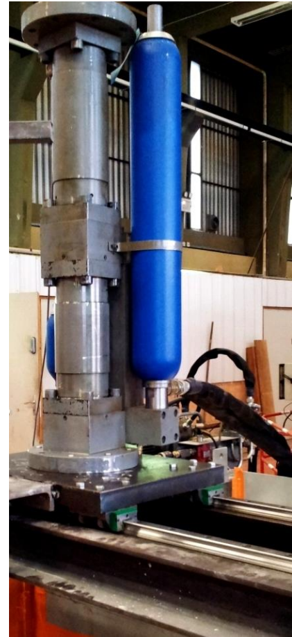
Figure 48 : Montage expérimental – Cuve de 2m 3 de volume partagée en deux compartiments et équipée d'un servo vérin (Dhaybi et Pellet, 2012) (à gauche), Servo vérin installé sur des railles et utilisé pour appliquer la charge verticale (à droite)
