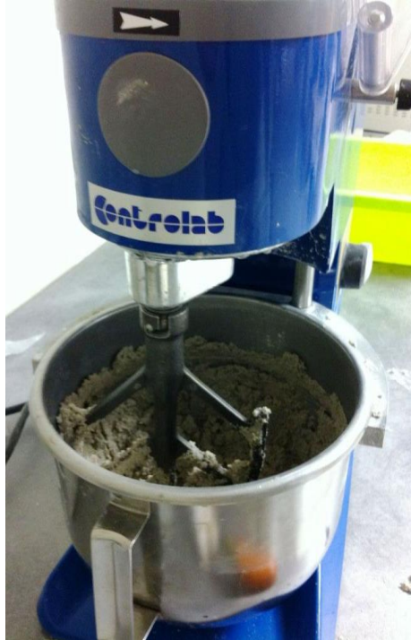
Figure 144 : préparation du mélange de soil mixing – Malaxage
