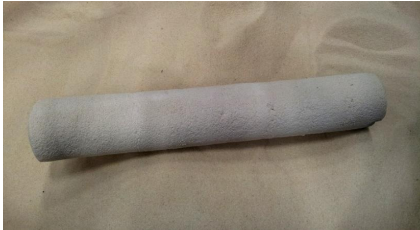
Figure 52 : Colonne de soil mixing exhumée après 14 jours
