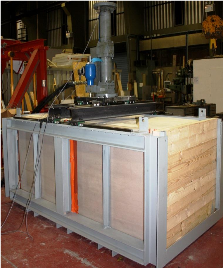
Figure 48 : Montage expérimental – Cuve de 2m 3 de volume partagée en deux compartiments et équipée d'un servo vérin (Dhaybi et Pellet, 2012) (à gauche), Servo vérin installé sur des railles et utilisé pour appliquer la charge verticale (à droite)
