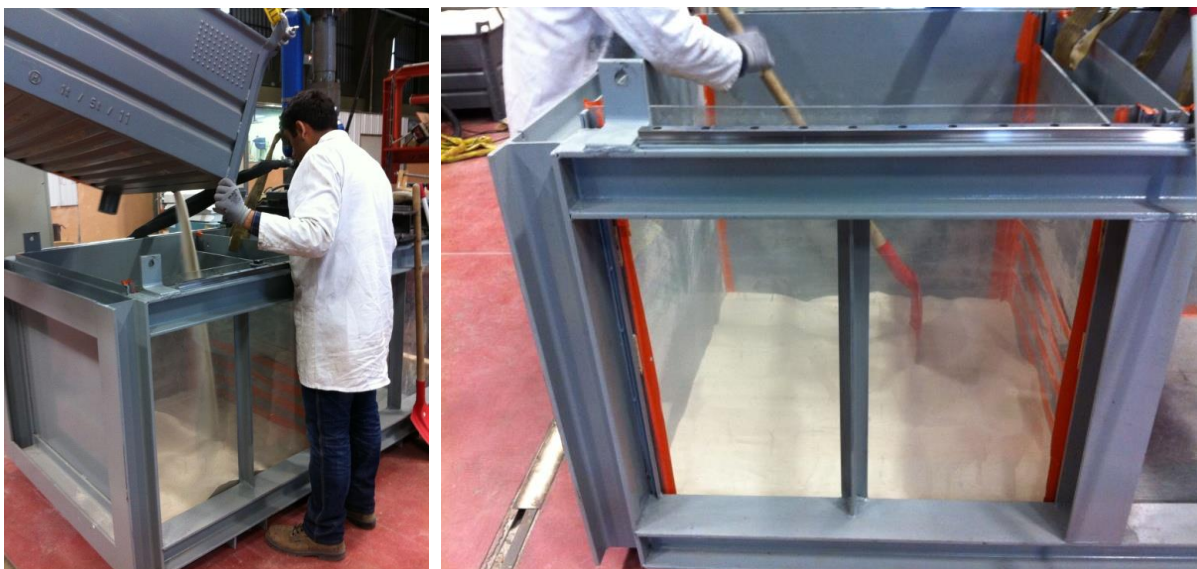
Figure 50 : Procédure de mise en place du sable d'Hostun dans la cuve (massif lâche)
