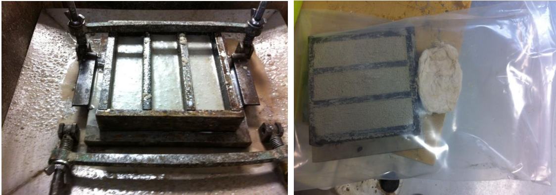
Figure 37 : Préparation des échantillons : la première couche après 60 chocs - moule dans un sac en plastique avec un papier mouillé
