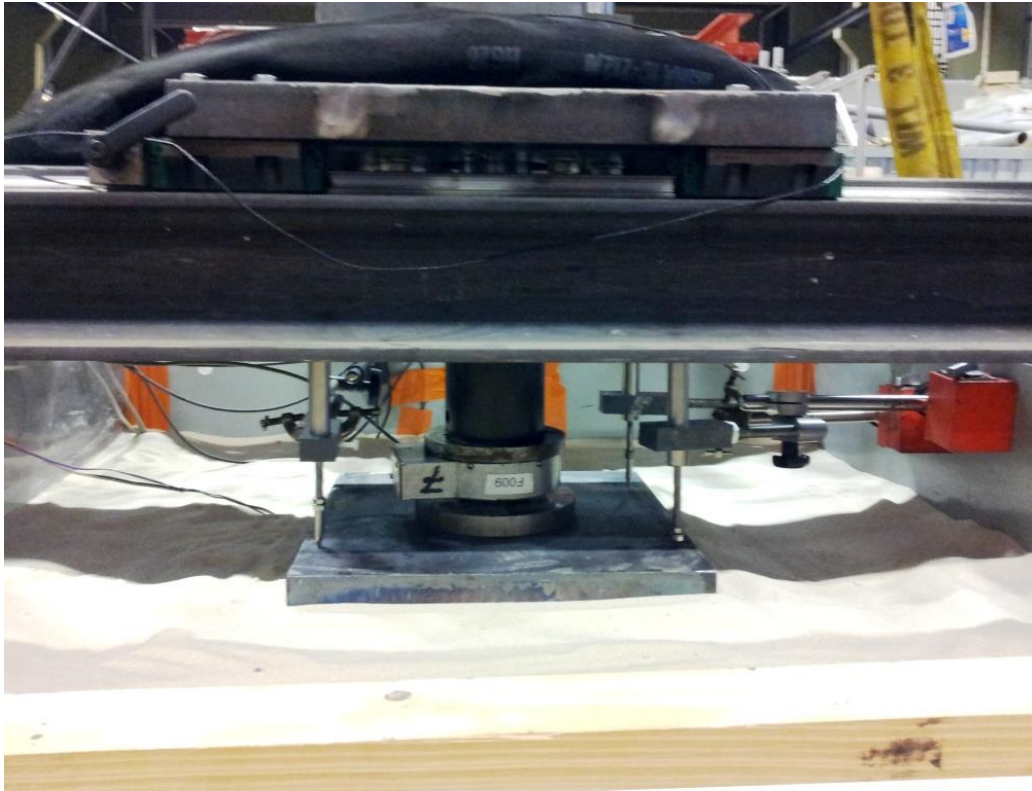
Figure 160 : essai de chargement d'une semelle renforcée – capteur de force entre la semelle et le vérin, 3 capteurs de déplacement aux coins de la semelle.
