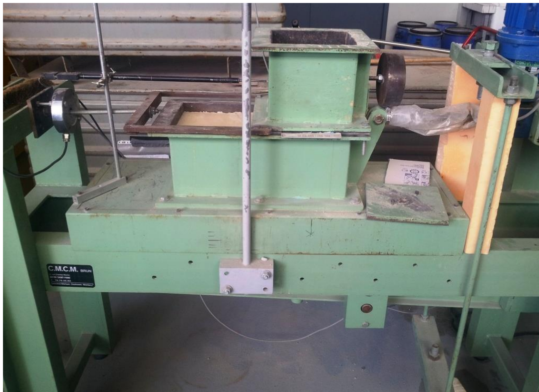
Figure 147 : boîte de cisaillement utilisée pour la détermination des paramètres d'interface sable d'hsotun/soil mixing
