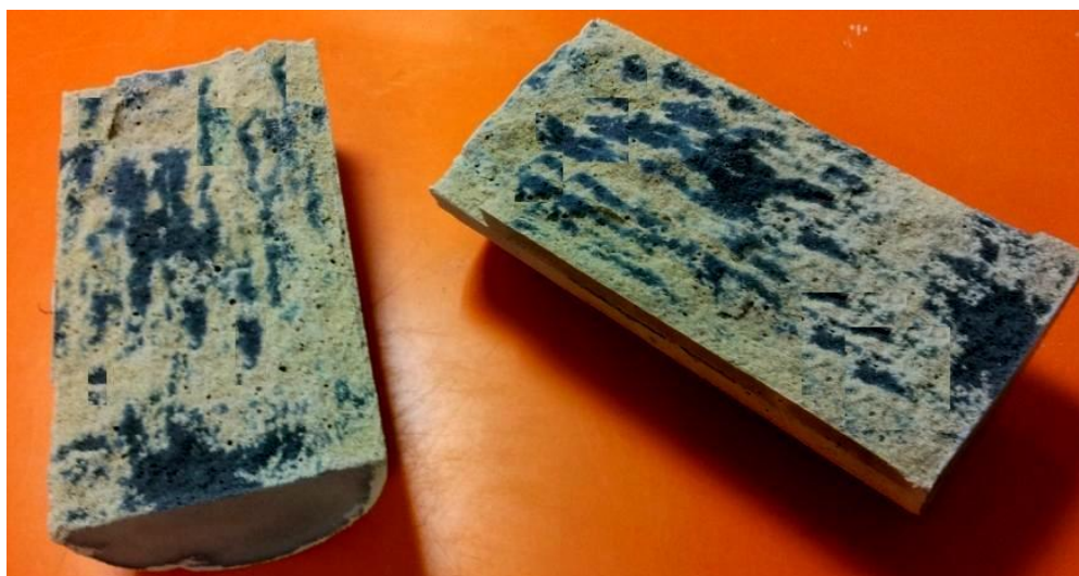
Figure 34 : Echantillon de soil mixing après un essai de traction (brésilien)
