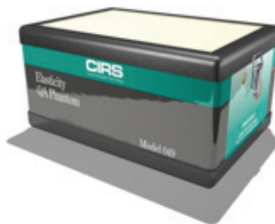
Figure 38: Fantôme d'élasticité CIRS Model 049 contenant 8 inclusions d'élasticité connu (Source d'image: CIRS)
