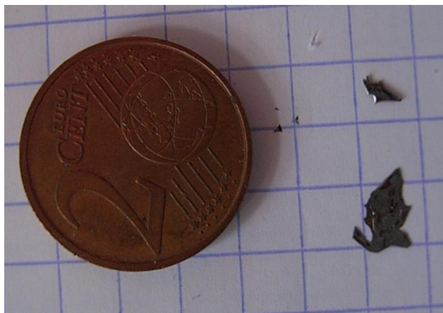
Figure 4.64 : Photographie de deux films libérés et recuits de composition Ni_{45,2}Co_{4,7}Mn_{36,2}In_{13,9} (le quadrillage correspond à des carrés de 5 \times 5 \text{ mm}^2 ).
