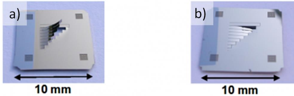
Figure 2.43: Effet des deux types de contraintes sur les poutres de silicium. Soit le film déposé est en compression a), soit il est en tension b).
