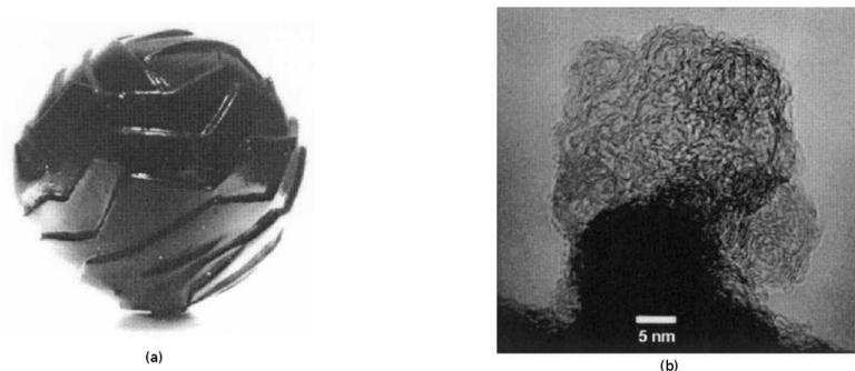
FIG. 2.4 – Modèle d’une particule de noir de carbone (20-50 nm); (b) micrographie MET de noir de carbone [Donnet, 2003].
