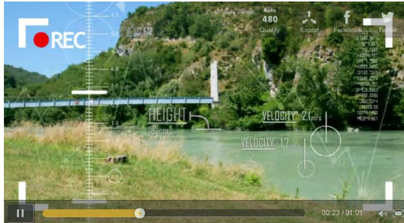
Figure A.5 – Mesures de hauteurs d'eau et de vitesses en surface par analyse d'images par le capteur RiverBoard® (cf. <http://tenevia.com/>).
