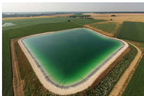
Figure I.2: Utilisation d'une géomembrane pour le stockage d'effluents agricoles industriels et agroalimentaires [4].
