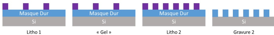
Fig. I.6 : Représentation schématique en coupe de la méthode LFLE
