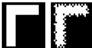
Fig. II.12 : A gauche, motif dans son format initial et à droite, son rendu après dithering (format lisible par la machine) [II.17]
